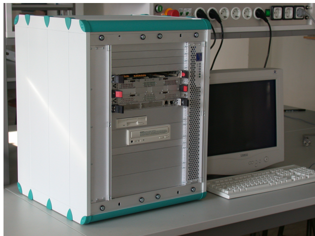
(b) Das Prozessormodul Benblue-II mit (c) 19"-Rack in einem geschlossenen Gehäuse mit zwei Virtex-II FPGAs und 4 MByte BenERA-Karten und einer Slot-CPU-Karte als Host-ZBT-SRAM. Rechner.
