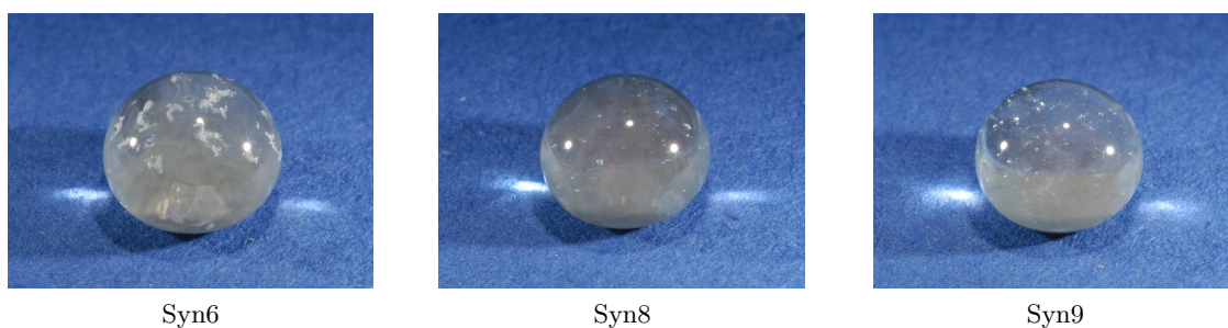
Abbildung 4.58: Erstarrte Tropfen des Systems SiO 2 -Al 2 O 3 -CaO-MgO
