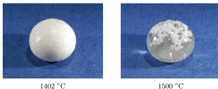
Abbildung 4.55: Erstarrte Tropfen der Zusammensetzung Syn5
