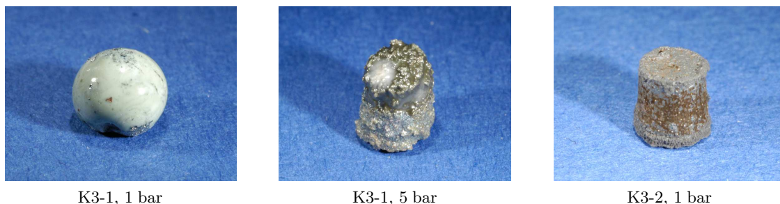
Abbildung 4.41: Erstarrte Tropfen/Proben der K3-1- und der K3-2-Asche
