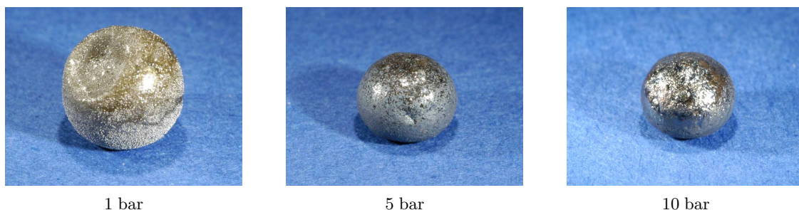
Abbildung 4.27: Erstarrte Tropfen der ST-D-6-Asche
