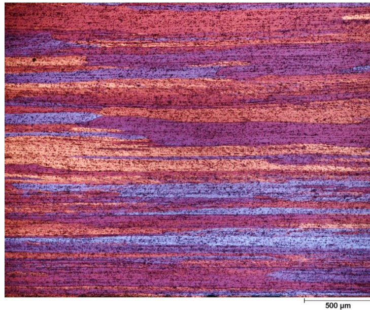
Abbildung 2.3: Das typische Verformungsgefüge einer 50% kaltgewalzten AA8079L Legierung.
