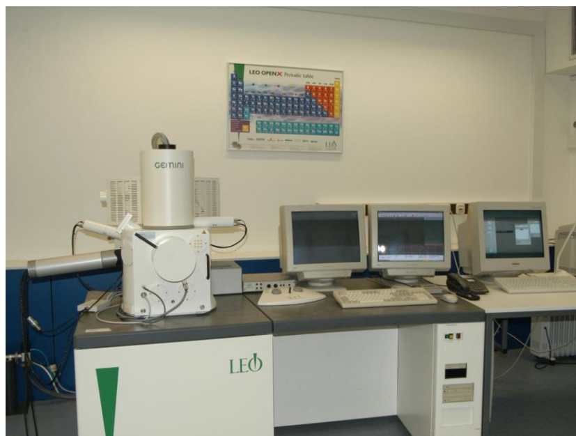
Abbildung 3.4: Feldemissions-Rasterelektronenmikroskop vom Typ LEO1530 am IMM.
