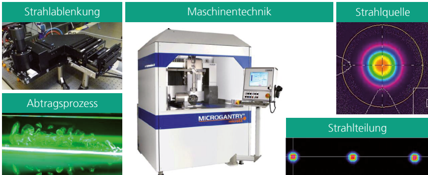
Abbildung 63: Übersicht über die Inhalte des Forschungsprojekts SEMILAS, welches das Ziel einer industrietauglichen Maschinenteknik zum Sublimationsschneiden von Silizium mit ultrakurz gepulster Laserstrahlung hatte.
