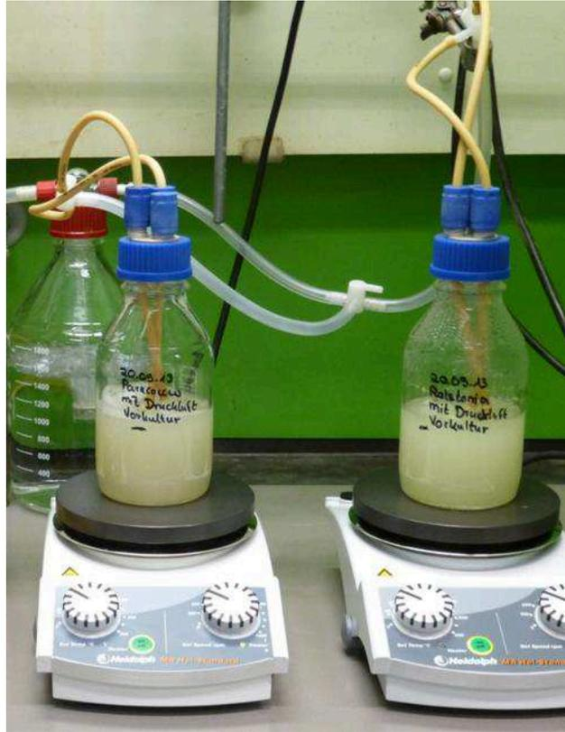
**Abbildung 12: Kultivierung der Bakterien bei Begasung mit Druckluft.**
