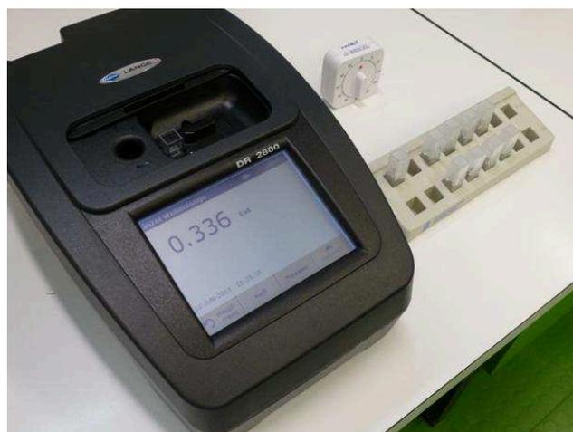
**Abbildung 50: Messung der Extinktionswerte mit dem Photometer.**
