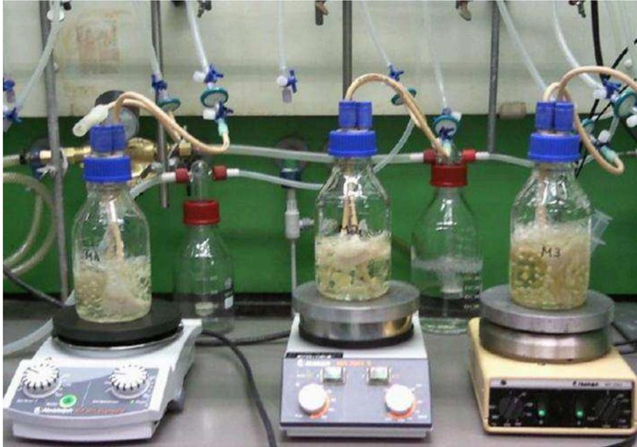
Abbildung 9: Kultivierung der Pilze bei Begasung mit Druckluft.
