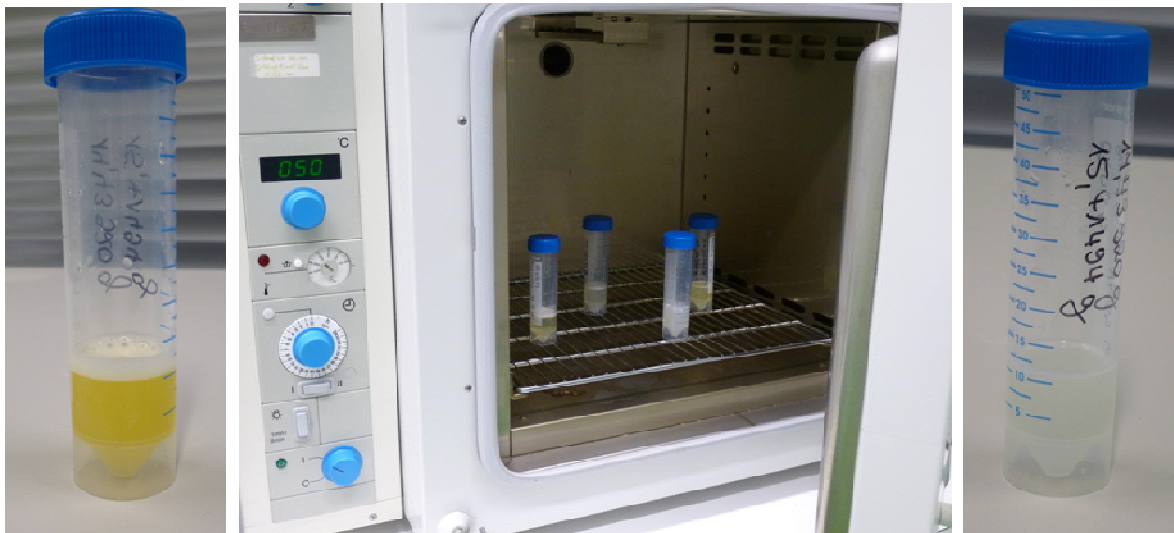
Abbildung 44: Zellpellet mit 10 % iger Natriumhypochlorit-Lösung (links), Zellaufschluss durch chemische Lyse bei 50°C im Trockenschrank (Mitte) und Falcon nach 1 Stunde bei 50°C im Trockenschrank (rechts).
