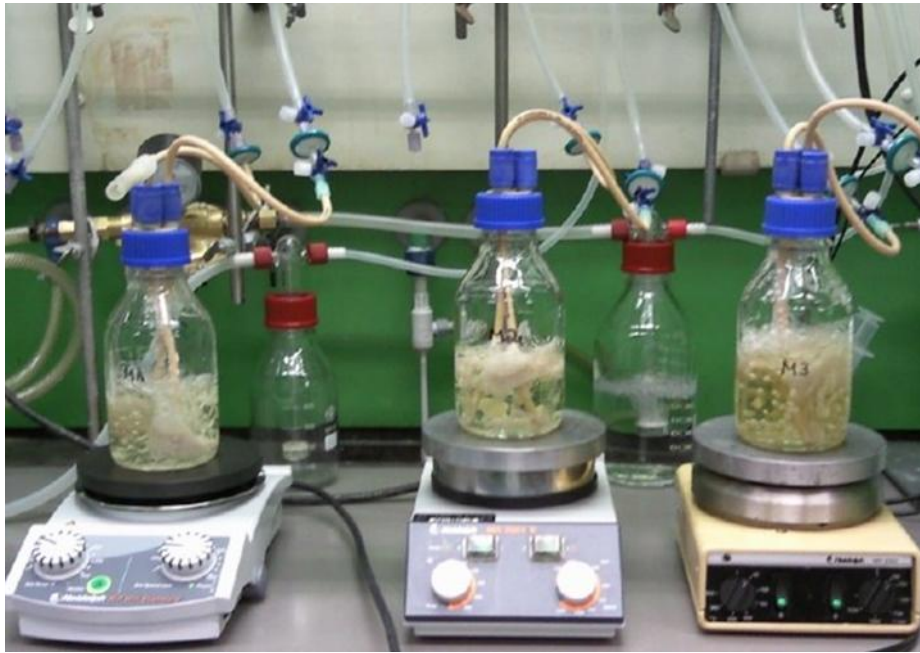
Abbildung 9: Kultivierung der Pilze bei Begasung mit Druckluft.
