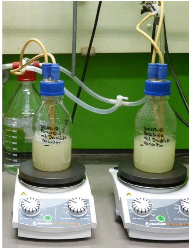
Abbildung 12: Kultivierung der Bakterien bei Begasung mit Druckluft.
