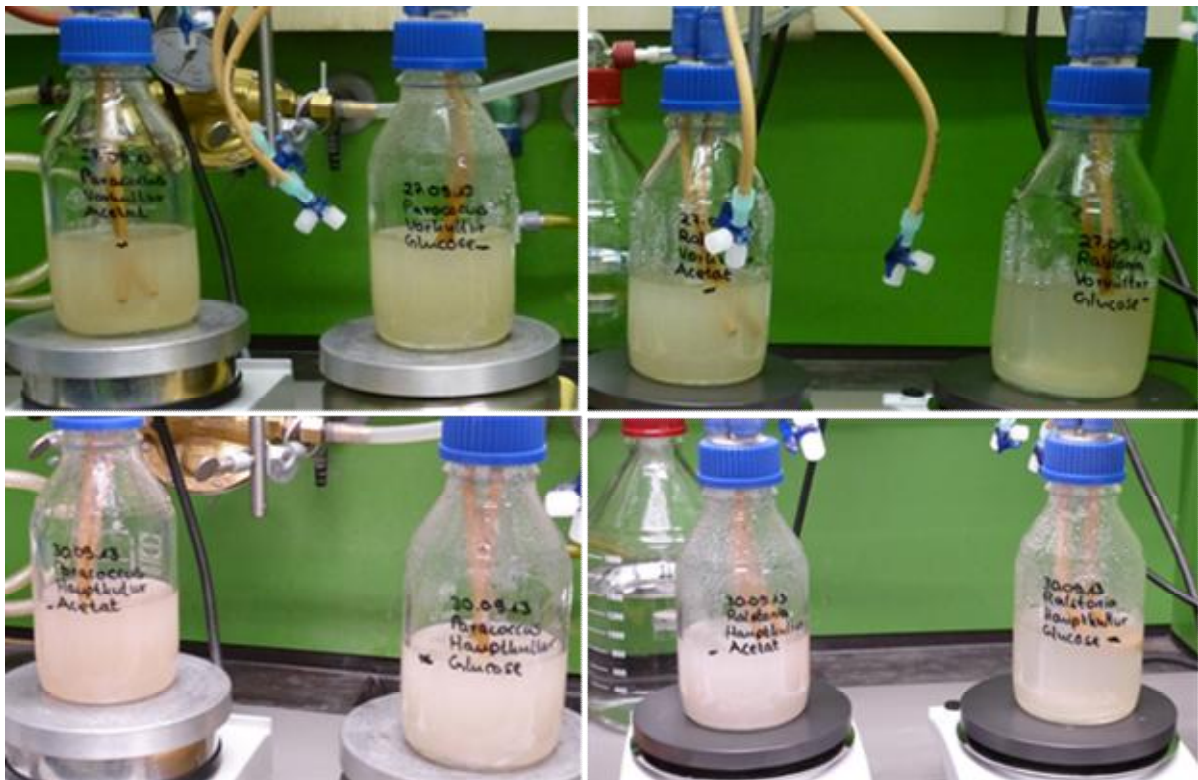
Abbildung 94: Ansätze bei Versuchsabbruch, Vorkulturen (oben), Hauptkulturen (unten), Paracoccus denitrificans (links) und Cupriavidus necator (rechts) im Medium mit Acetat und Glucose.
