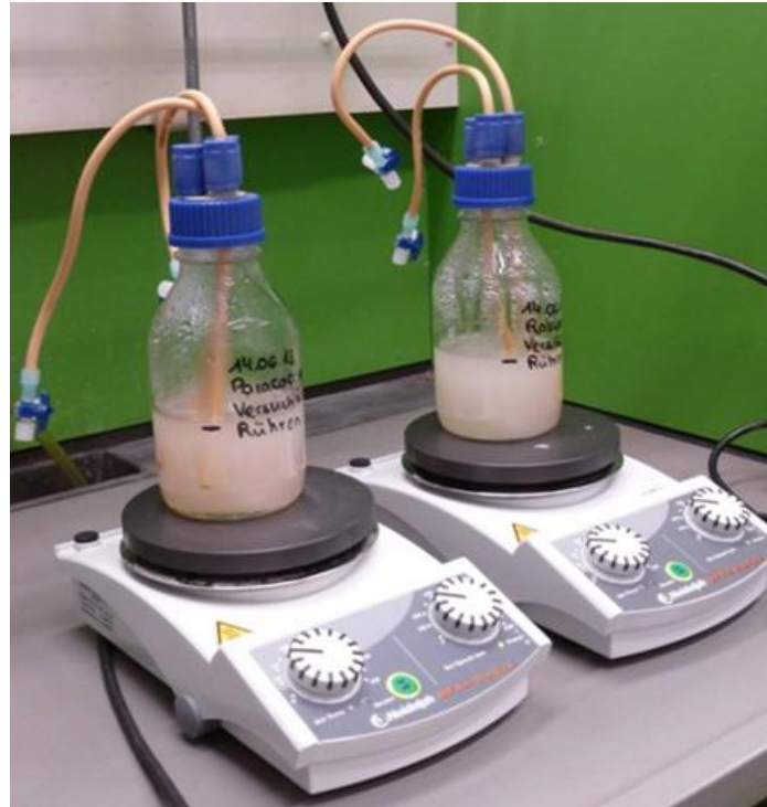
Abbildung 11: Kultivierung der Bakterien mit Sauerstoffeintrag durch Rühren.
