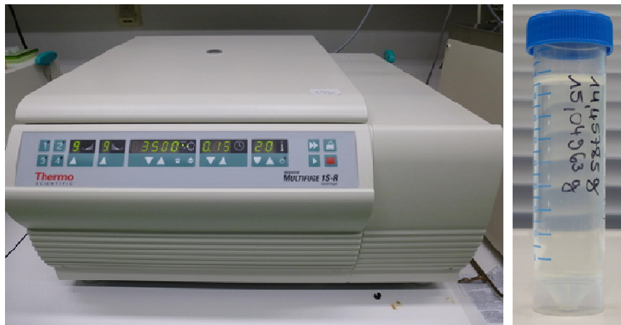
Abbildung 46: Zentrifugation (links) und Falcon nach 15 minütiger Zentrifugation bei 3500 rpm (rechts).
