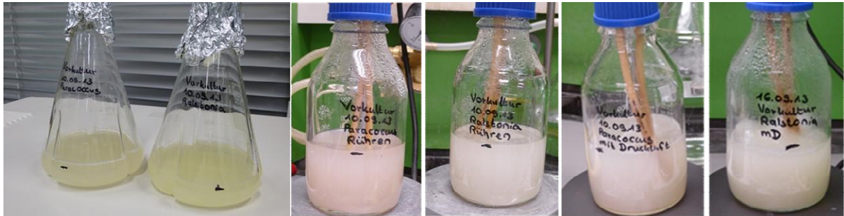
Abbildung 93: Vorkulturen bei Versuchsabbruch, Paracoccus denitrificans (links), Cupriavidus necator (rechts), Ansatz im Schüttelschrank (links), Ansatz Sauerstoffeintrag durch Rühren (Mitte) und Ansatz Begasung mit technischer Luft (rechts).
