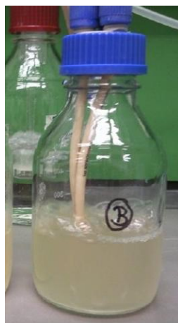
Abbildung 91: Aussehen des Ansatzes mit Prozesswasser der Brauerei Erding nach 70 Stunden.
