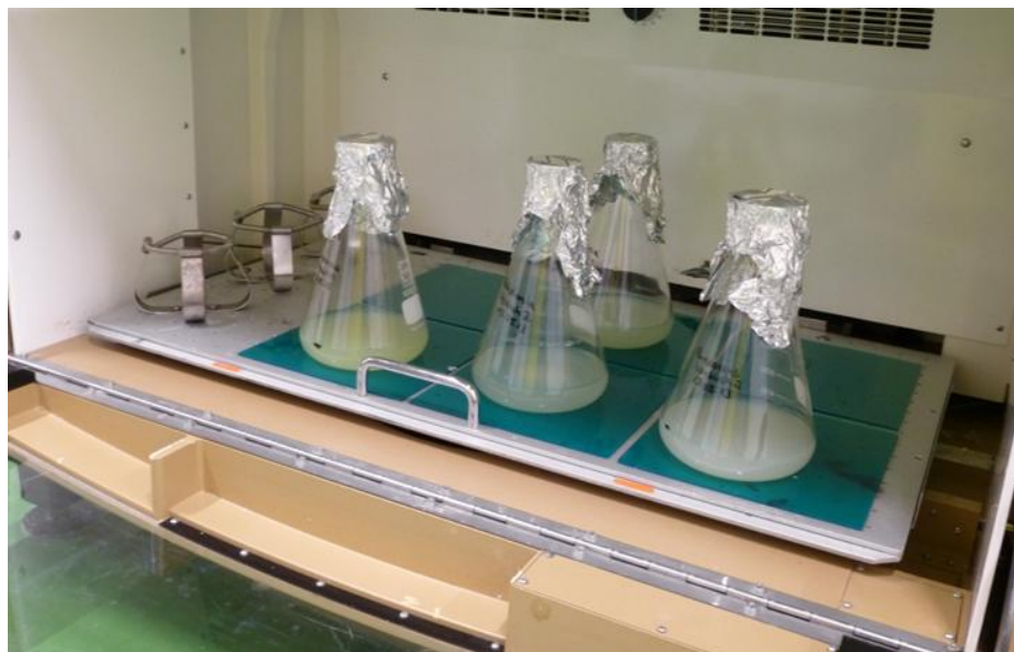
Abbildung 10: Kultivierung der Bakterien im Schüttelschrank.
