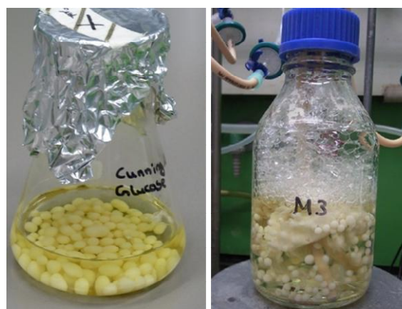
Abbildung 75: Kultivierung des Pilzes Cunninghamella elegans (Stamm 1908) im Schüttelschrank (links) und aktive Belüftung mit technischer Luft (rechts).
