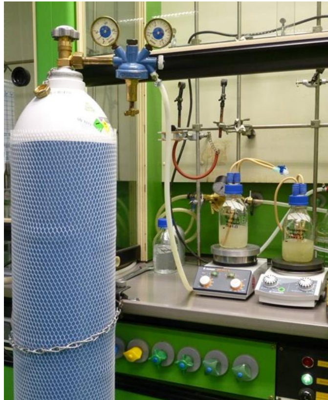
Abbildung 13: Kultivierung der Bakterien bei Begasung mit Sauerstoff.
