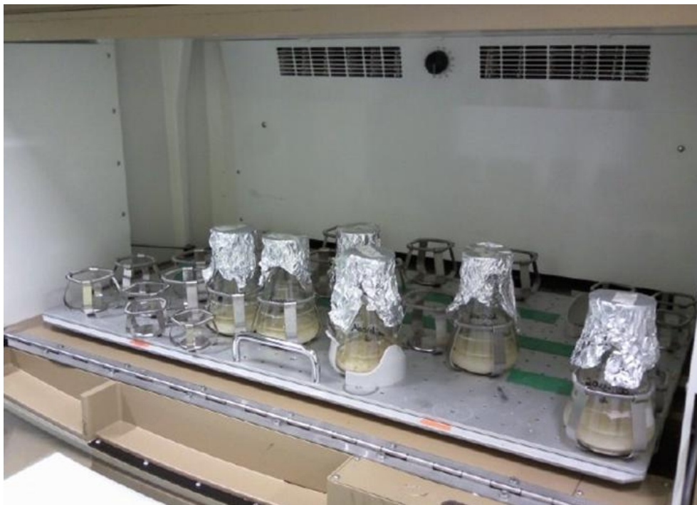
Abbildung 8: Kultivierung der Pilze im Schüttelschrank.
