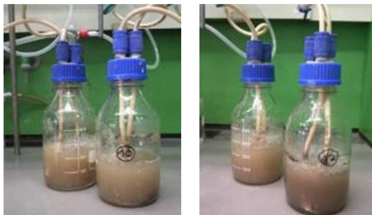
Abbildung 53: Wachstum der Mischkultur im Minimalmedium (links) und im Reaktionsmedium (rechts) nach 192 Stunden.
