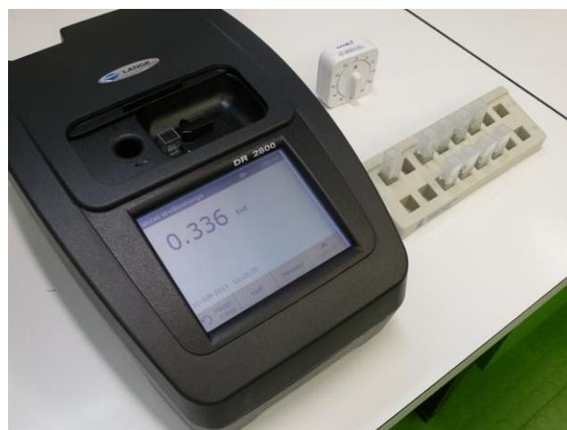
Abbildung 50: Messung der Extinktionswerte mit dem Photometer.
