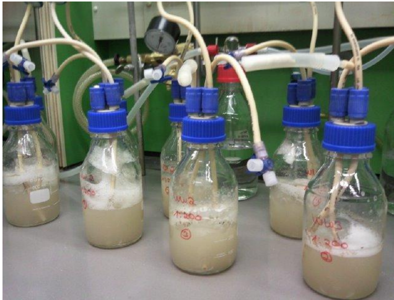
Abbildung 88: Aussehen der Ansätze mit Budenheim-Waschwasser 1 bis 3 nach 72 Stunden (bei jeweils 2 Parallel-Ansätzen).
