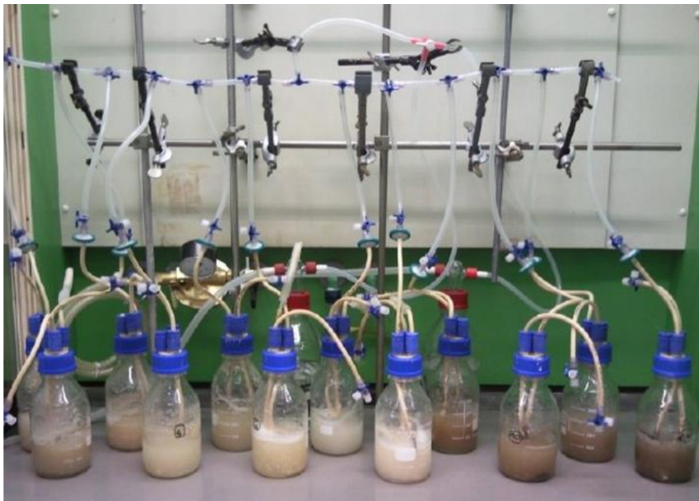
Abbildung 7: Kultivierung der Mischkulturen bei alternierender Begasung mit Druckluft und Stickstoff.
