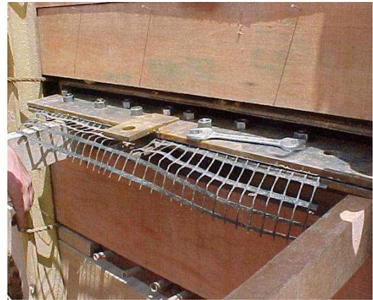
**Bild 2.23 In-situ-Herausziehversuche aus einer Kastenfangedamm-artigen Konstruktion (Becker, 2006).**
