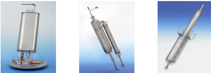
Abbildung 15.1: Wassergas-Shift-Reaktoren der Generationen 3, 4 und 5 (v.l.n.r.) des IEK-3.
