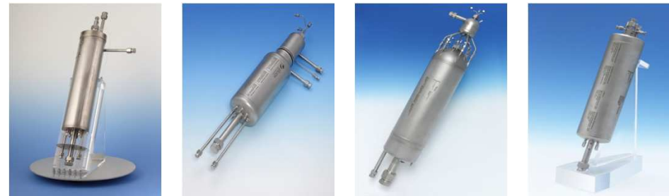
Abbildung 15.2: Autotherme Reformer-Reaktoren der Generation 8, 9.2, 10 und 13 (v.l.n.r.) des IEK-3.
