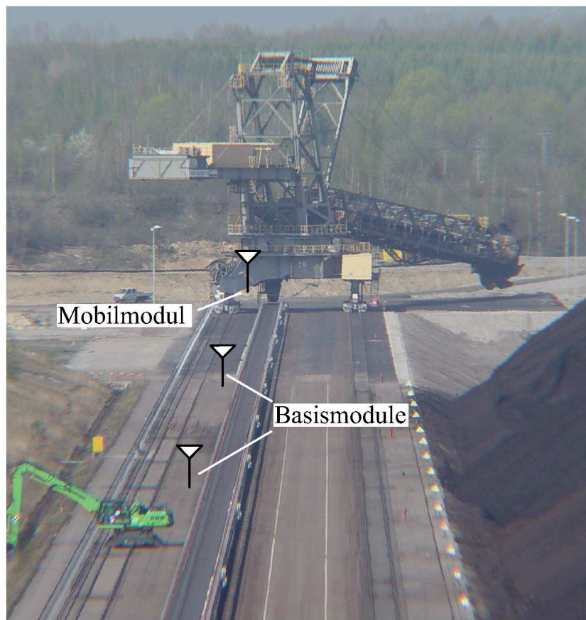
Abbildung 6.1: Messaufbau der 1D-Messung am Kohlenmischplatz.
