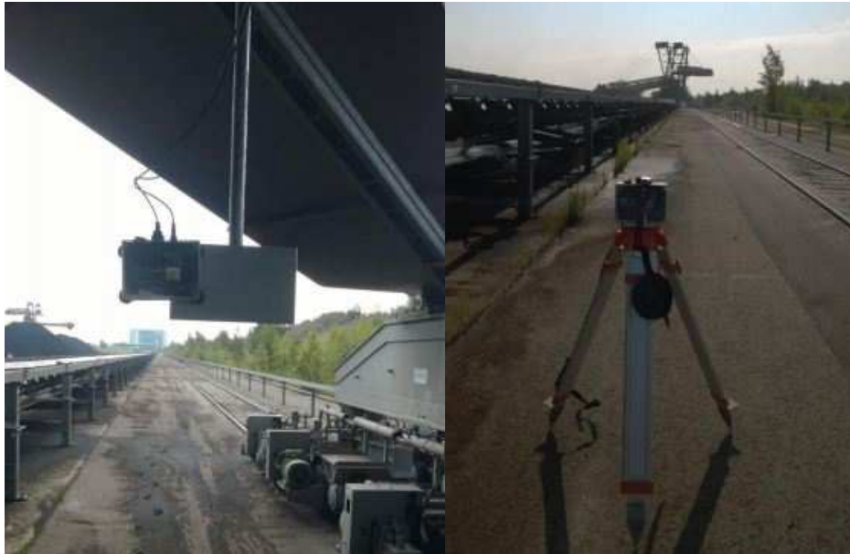
(a) Anbringung des Mobilmoduls am Bag- (b) Aufstellung des Ankermoduls. ger.
