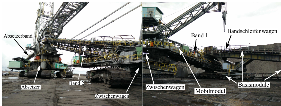
Abbildung 6.8: Aufbau der Positionsbestimmung für den Anwendungsfall Absetzer.
