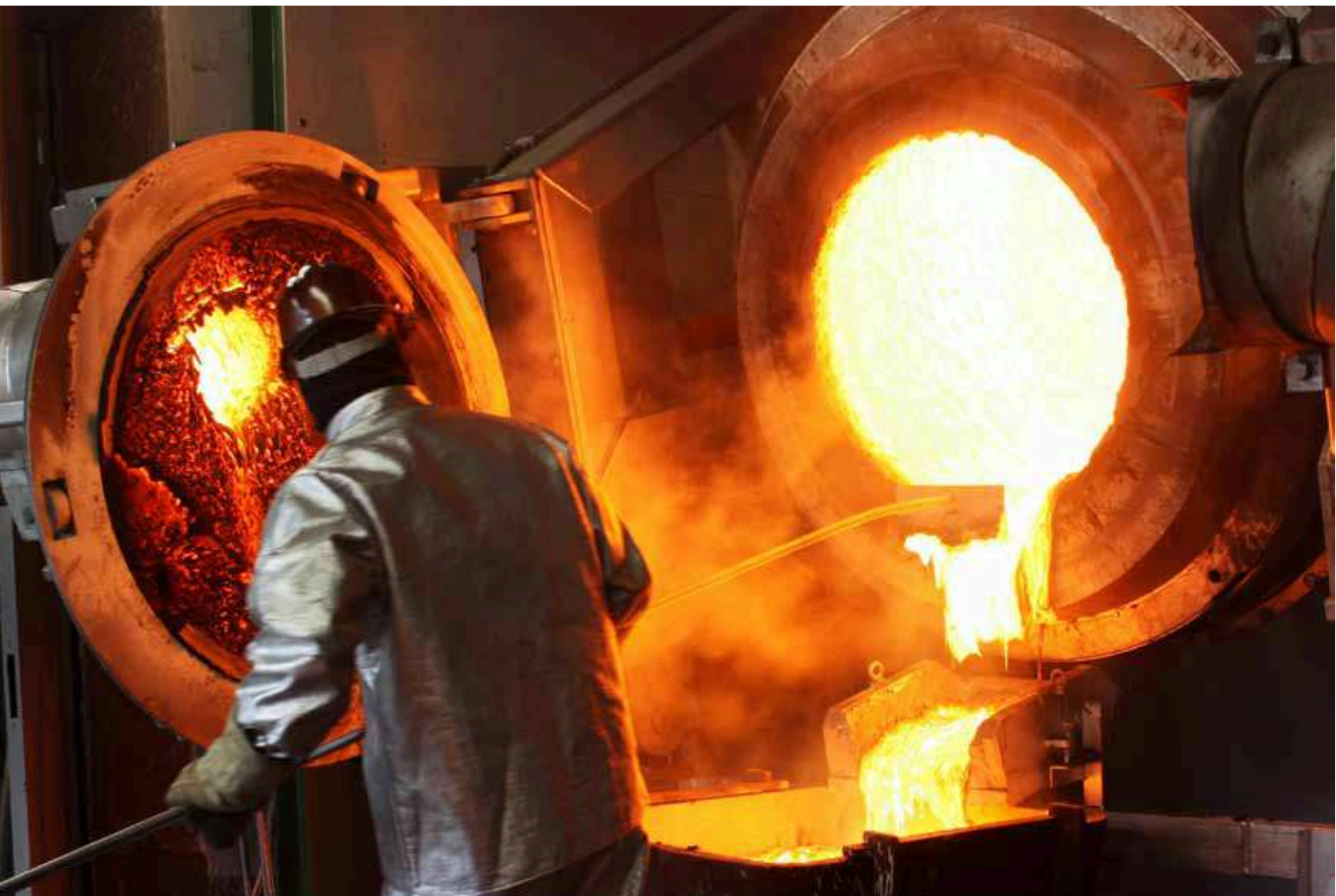
Bild 2: Pyrometallurgische Verarbeitung von Elektronikschrott bei Temperaturen von bis zu 1400 Grad Celsius.
