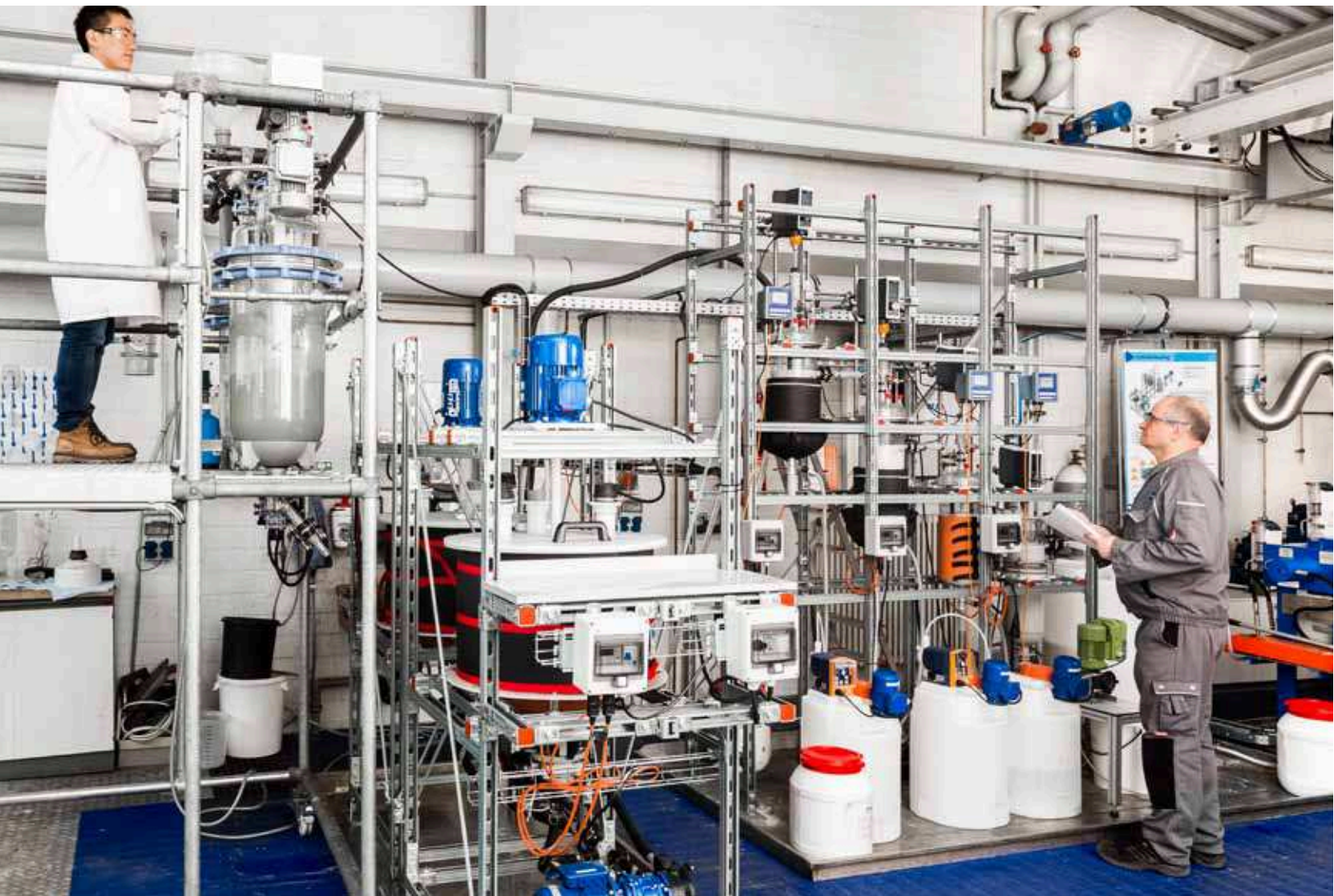
Bild 3: Nass-Chemische Wertmetall-Rückgewinnung aus Elektronikschrott in der Kaskadenstraße.
