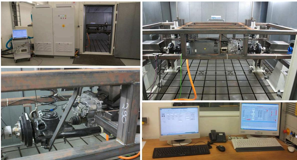
Abbildung A.4: Antriebsstrangprüfstand in Schallschutzkabine mit Steuerungszentrale für An- und Abtriebsmotoren
