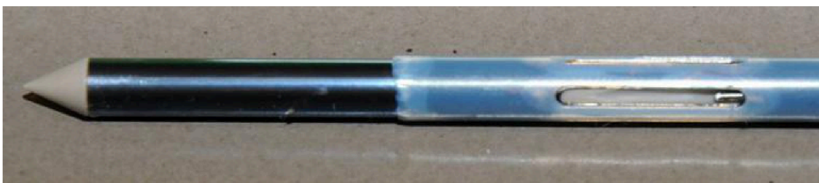
Abbildung 5.4: Ansicht wie in Abbildung 5.3 unten, jedoch mit eingefahrenen Satellitenelektroden. Zu erkennen sind die Führungsschienen (weiß) und die Spitze einer Satellitenelektrode.
