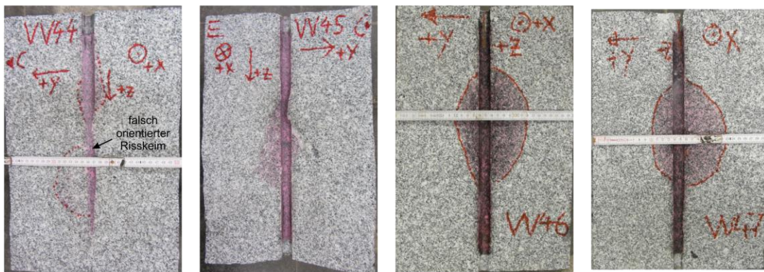
Bild 5.34: VV44–VV47, Spaltebene der Probenhälften mit gefärbtem Rissbereich (+y bei Versuch VV45 gedreht, bzw. andere Probenhälfte).
