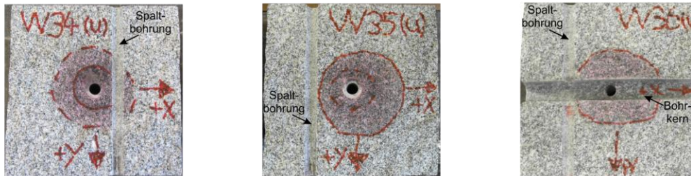
Bild 5.13: VV34–VV36, Spaltebene der unteren Probenhälfte mit gefärbtem Rissbereich.
