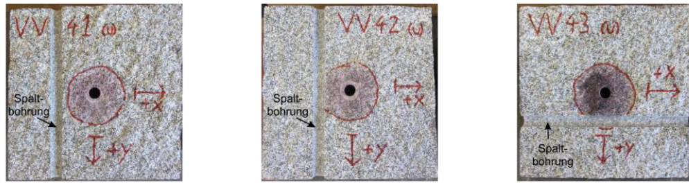
Bild 5.23: VV41–VV43, Spaltebene der unteren Probenhälfte mit gefärbtem Rissbereich.
