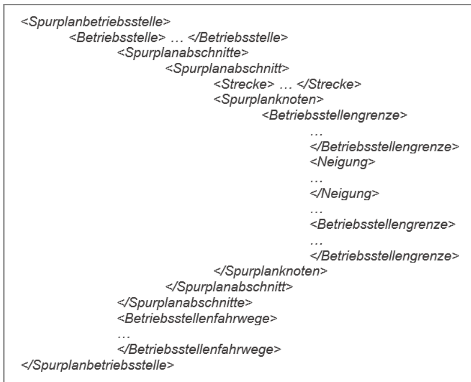
Abbildung 6: Datenstruktur der XML-ISS-Eingangsdaten
