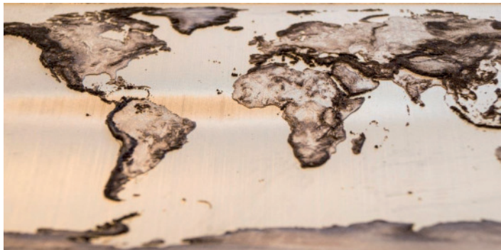
Abbildung 6: Exemplarisches Strukturierungser- gebnis mit der To- pografie der Ko- ntinente in Messing
