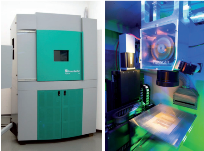
Abbildung 19: Ansichten des rea- lierten Polygo- nscannersystems
