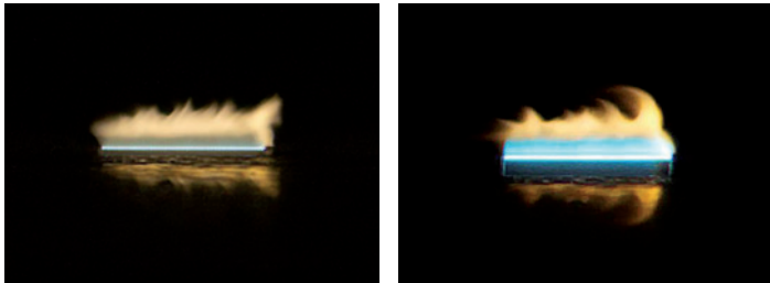
Abbildung 32: Visualisierung des Rückimpulses des Prozesses anhand der Orientierung des Prozessleuch- tens Links: Ohne Druckluft Rechts: Mit Druckluft
