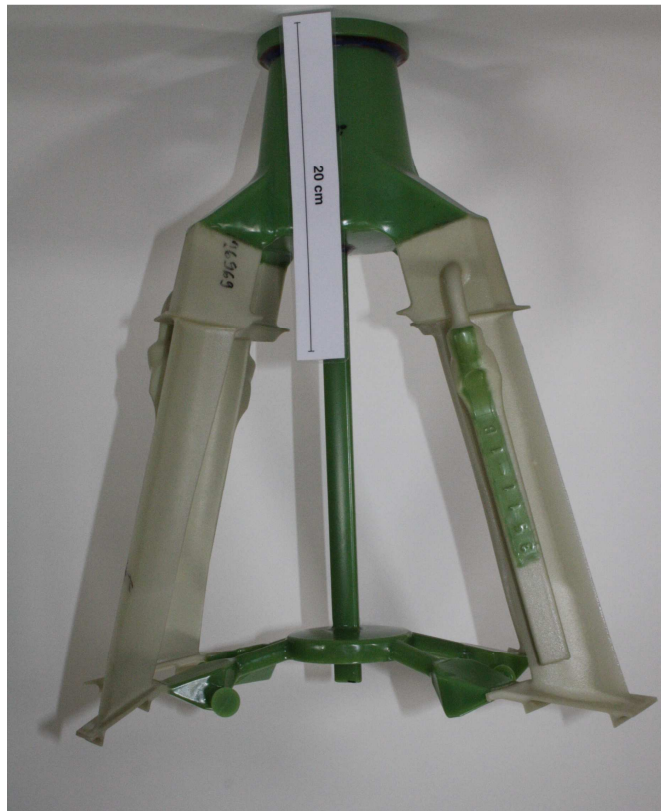
Abbildung 4.8: 4er Cluster aus RP-Modellen mit Linienblattspeiser
