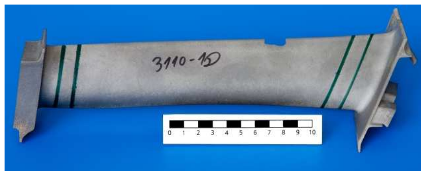
Abbildung 4.7: Gegossene TATT-Schaufel mit Kaltlauf
