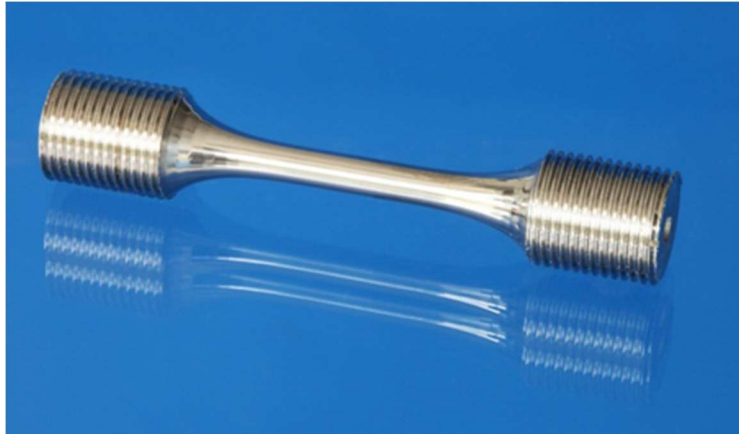
Abbildung 3.4: Polierter Prüfkörper zur Durchführung von Zugversuchen [40]
