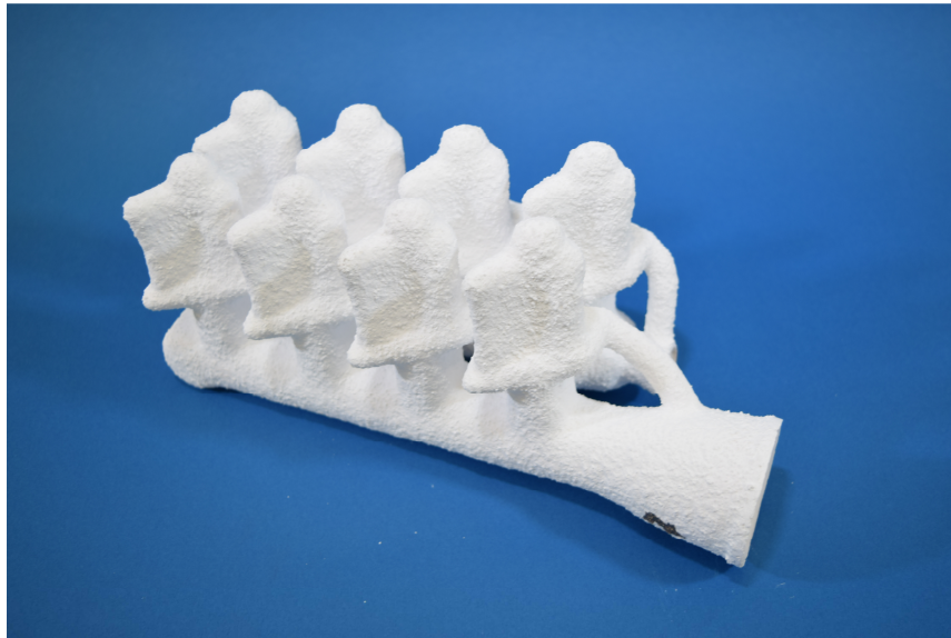
Abbildung 5.11: Keramische Formschale mit 8 HPT-Schaufeln
