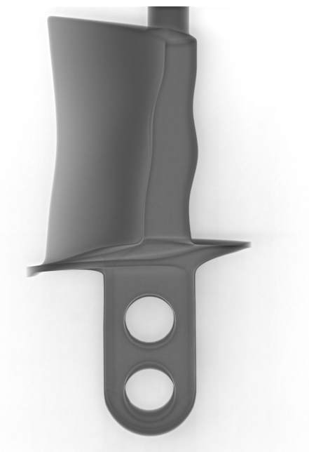
Abbildung 5.18: Röntgenaufnahme einer Gusschaufel
