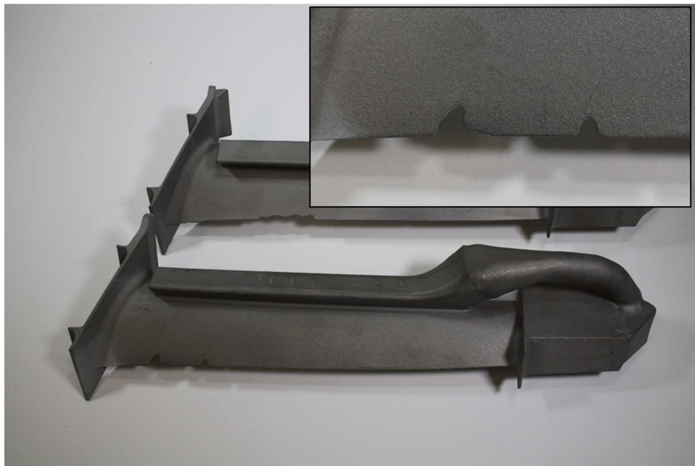
Abbildung 4.10: Abguss der TATT-Schaukel mit Linienblattspeiser
