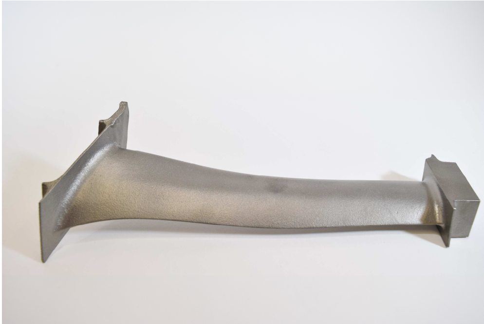
Abbildung 3.36: Abguss der optimierten TATT-Schaufel
