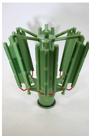
Abbildung 3.1: Wachsmodell eines Probekörper-Clusters
