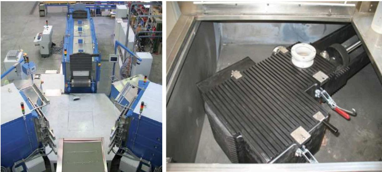
**Abbildung 5.12:** Linn Supercast und Schleuderkammer
