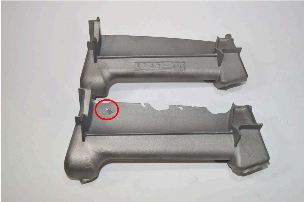
**Abbildung 6.4:** Abguss der verschiedenen L1-Geometrien
