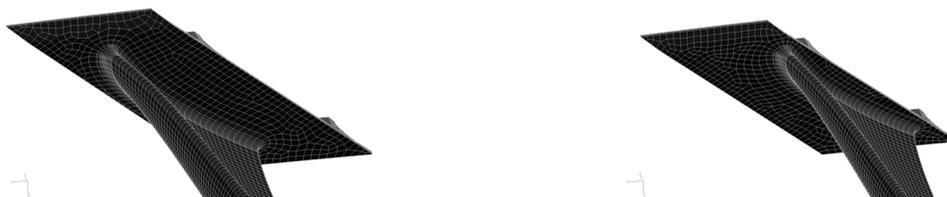
Parametrische  $\theta$ -Verschiebung des Deckbandes relativ zum Schaufelblatt
