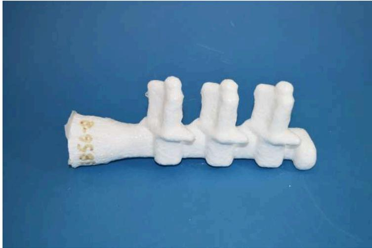
**Abbildung 5.15:** Keramische Formschale Alternativkonzept
