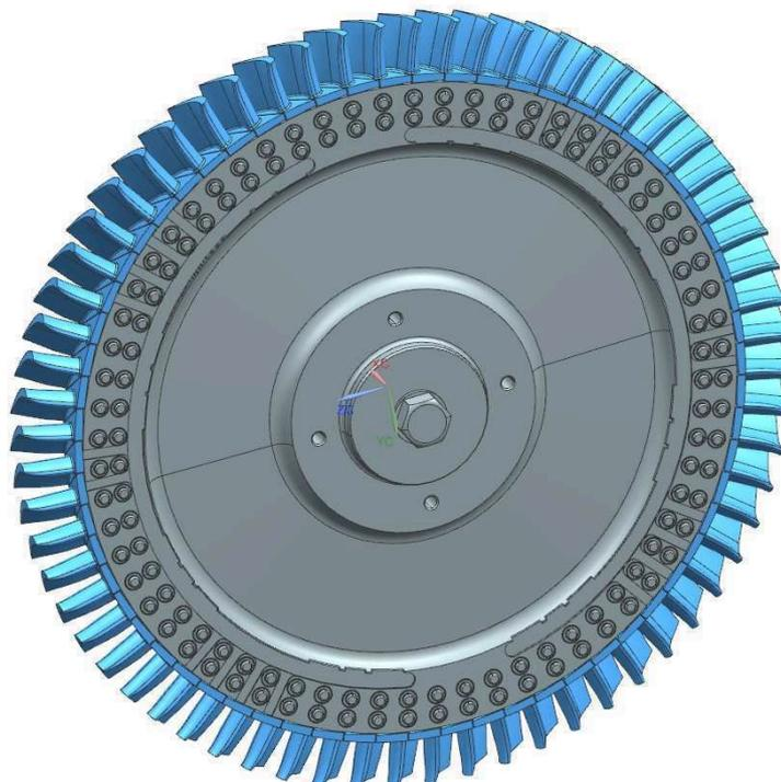
**Abbildung 5.21:** Mit 64 HPT-Schaufeln bestückte Rotorscheibe des Prüfstands
