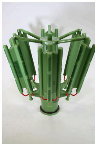
**Abbildung 3.1:** Wachsmodell eines Probekörper-Clusters
