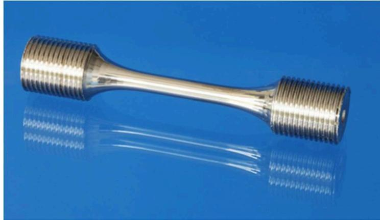
**Abbildung 3.4:** Polierter Prüfkörper zur Durchführung von Zugversuchen [40]
