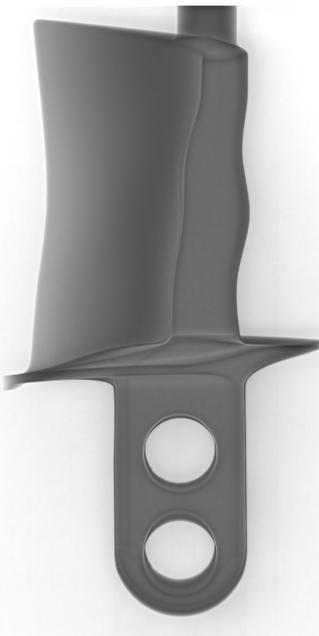
**Abbildung 5.18:** Röntgenaufnahme einer Gusschaufel
