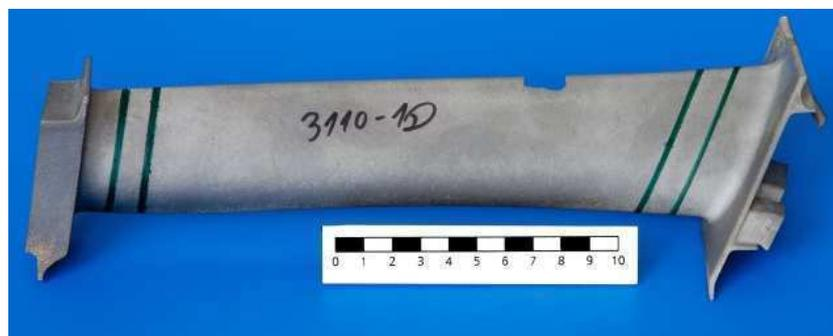
**Abbildung 4.7:** Gegossene TATT-Schaufel mit Kaltlauf
