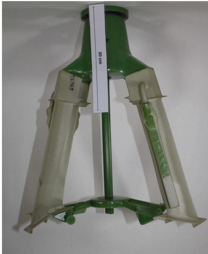
**Abbildung 4.8:** 4er Cluster aus RP-Modellen mit Linienblattspeiser
