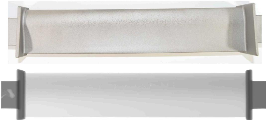
**Abbildung 4.48:** Exemplarische, unbearbeitete Röntgenaufnahme eines Gruppe B-Probekörpers
