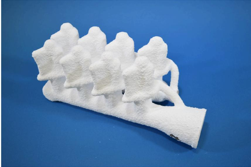
**Abbildung 5.11:** Keramische Formschale mit 8 HPT-Schaufeln
