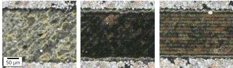
Bild 42: Mit 200 fs-Pulsen der Spitzenintensität 7,2 \cdot 10^{12} \text{ W/cm}^2 bestrahlte Proben- oberfläche bei steigender Wiederholung: links 1 Wiederholung, mittig 6 Wiederholungen, rechts 12 Wiederholungen, Überlapp 83 %, Wellenlänge 1028 nm
