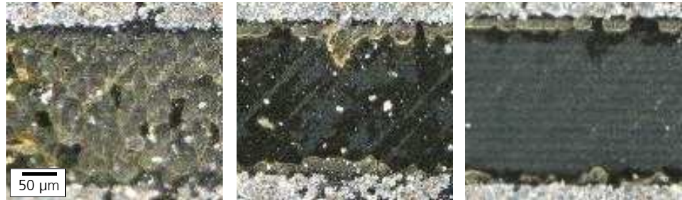
Bild 39: Mit 10 ps-Pulsen der Spitzenintensität 1,6 \cdot 10^{11} \text{ W/cm}^2 bestrahlte Proben- oberfläche bei steigender Wie- derholung: links 1 Wiederho- lung, mittig 6 Wiederholun- gen, rechts 12 Wiederholun- gen, Überlapp 83 %, Wellen- länge 1028 nm
