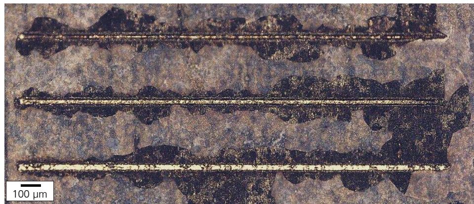
Bild 38: Mit 27 ns-Pulsen der Spitzenintensität 1,9 \cdot 10^{14} \text{ W/cm}^2 bestrahlte Proben- oberfläche bei steigender Wieder- holung, obere Linie 2 Wieder- holungen, mittlere Linie 4 Wiederholun- gen, untere Linie 6 Wiederholun- gen, Über- lapp 84 %, Wel- lenlänge 1060 nm
