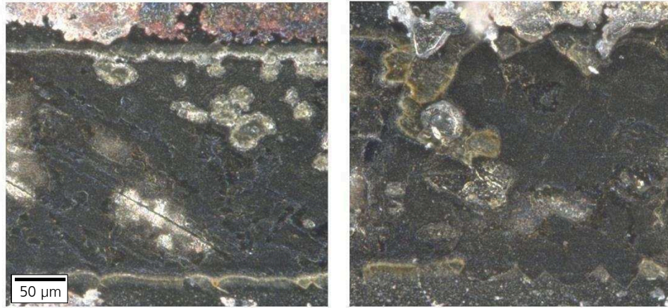
Bild 46: links: Probenoberfläche nach 10 Überfahrten mit 200 fs-Pulsen der Spitzenintensität 7,2 \cdot 10^{12} \text{ W/cm}^2 , rechts: Probenoberfläche nach 10 Überfahr- ten mit 10 ps-Pul- sen der Spitzenin- tensität 1,6 \cdot 10^{11} \text{ W/cm}^2 , Überlapp 83 %, Wellenlänge 1028 nm
