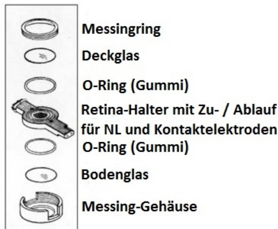
Abb. 3.3: Zusammenbau der Versuchskammer
