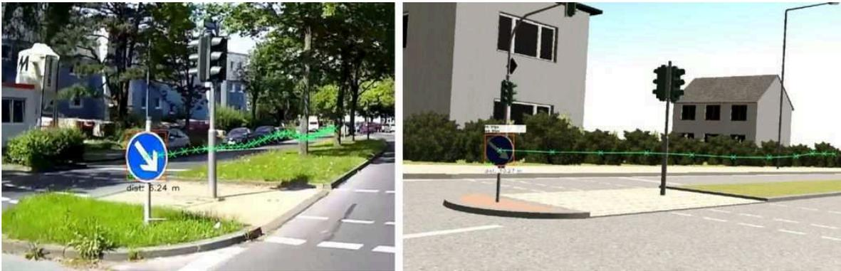
ABBILDUNG 7.18: Bildbasierte Detektion und Entfernungsschätzung von Verkehrsschildern. Links: Ein Verkehrsschild wird Detektiert und über die Zeit verfolgt. Rechts: Eine Auswertung der Verkehrszeichendetektion im Virtuellen Testbed. Bilder: A. Atanasyan, MMI
