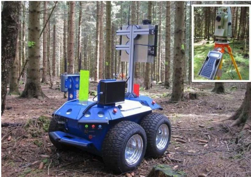
ABBILDUNG 5.11: Durch Vermessungsingenieure werden die Lokalisierungsergebnisse validiert. Der Roboter ist dazu mit zwei Markerplatten (rot und gelb) ausgestattet, die mit einem Theodolit angepeilt und eingemessen werden. Dadurch wird ebenfalls die Orientierung des Roboters berücksichtigt.
