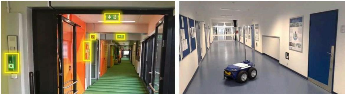
ABBILDUNG 7.10: Beispiele zur Servicerobotik in öffentlichen Gebäuden. Links: Semantische Objekte, die zur Lokalisierung geeignet sind. Rechts: Mobiler Roboter, der sich anhand künstlicher Marker orientiert.
