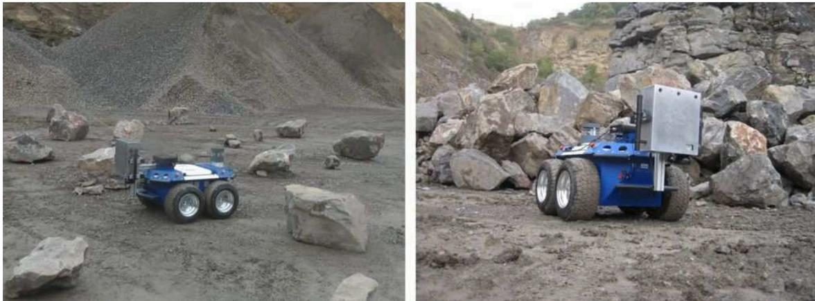
ABBILDUNG 7.7: Reales Testbed für Planetenexploration in Steinbruch
