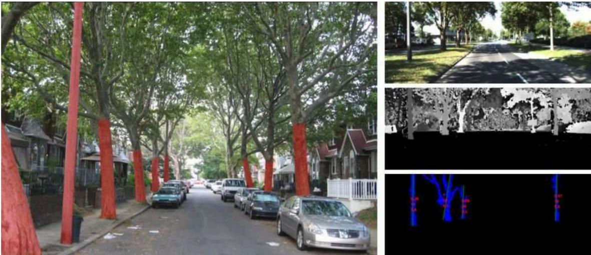
ABBILDUNG 7.16: Baumdetektion zur Verbesserung der Fahrzeuglokalisierung. Links: Verwendung erkannter Baumlandmarken zur Lokalisierung bei fehlender Fahrbahnmarkierung. Rechts: Landmarkendetektion auf Basis von Stereobilddaten.
