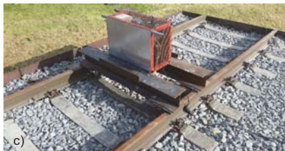
Abbildung 4-16 a) Bereich Koppelfuge ohne Schwellen und Schienen, b) Einbau Schwellen und Schienen c) Unwuchterreger auf Überbau 1 d) Fugenbereich im fertigen Zustand
