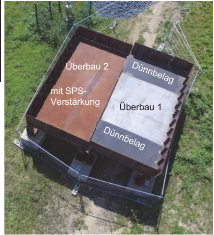
Abbildung 4-13: Leere Brücke (Federn + Überbau + Begrenzungsbox)
