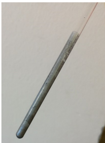
Abbildung 21: NMR-Rohr mit der Reaktionslg. der Umsetzung von B_2pin_2 und ZnEt_2 ohne NEt_3 .
