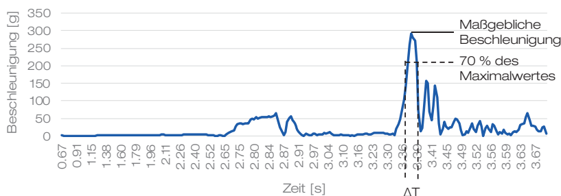
Abbildung 4.9: Ermittlung der Dauer einer maßgeblichen Beschleunigung zur Unterscheidung zwischen einem Scherereignis und einer Kollision (nach: DENG ET AL., 2005)
