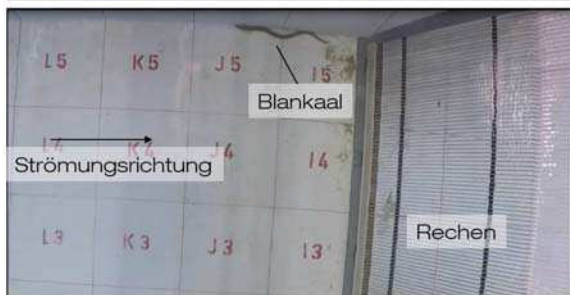
Abbildung 2.2: Umkehrreaktion eines Aals in der ethohydraulischen Versuchsrinne des IWW (KLOPPRIES ET AL, 2016)
