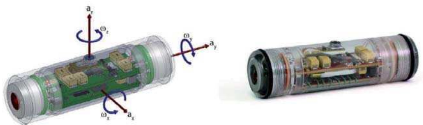
Abbildung 4.52: Sensorfisch links: CAD-Modell, rechts: Foto (DENG ET AL., 2017)
