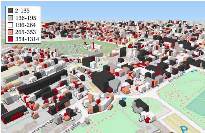
Abbildung 5.13: Ausschnitt der 3D-Ansicht einer exemplarischen Wärmelastkarte für Bad Godesberg. Alle Angaben in \text{kWh}/(\text{m}^2\text{a}) .
