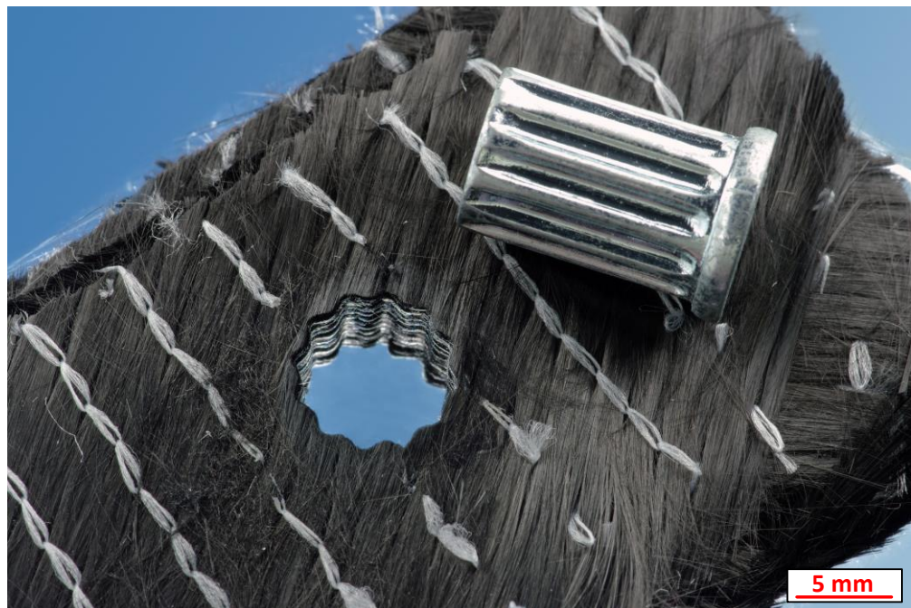
Bild 80: Foto einer mittels UKP-Laserstrahlung hergestellten sternförmigen Formbohrung nebst zugehörigem M6 KIM® Metallinsert
