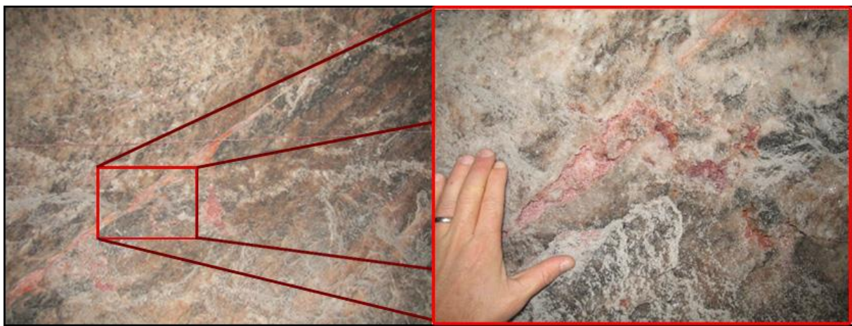
Abbildung 7.2: Mit Carnallit verheilte Bruchstruktur im Schwadensalz (z3NAh), Wendel 403/385 m Sohle, Profil 75.
