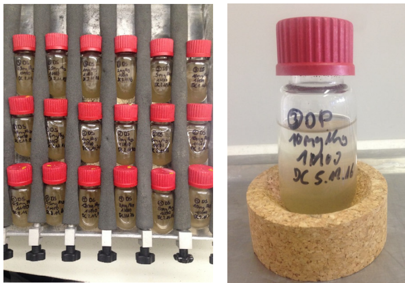
Abbildung 3.3: Testsystem zur Bestimmung der GG für die Adsorption und Desorption, sowie die Sorptions- und Desorptions-Isothermen für ^{14}\text{C} -DP, ^{14}\text{C} -DS ^{-} und ^{14}\text{C} -DA ^{+} im Boden 5M.
