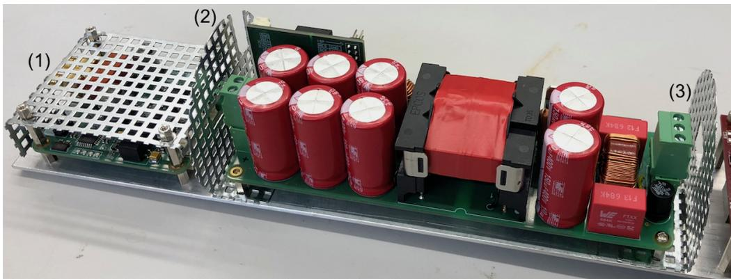
**Abb. 3.30.:** EMI -Abschirmungen des Pinger Front-End (1) und der Spannungsversorgung Pinger (2 - 3)
