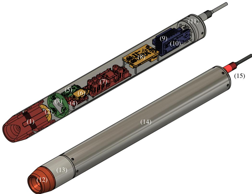
**Abb. 1.6.:** Technische Zeichnung einer APU im Querschnitt und in geschlossenem Zustand: (1) APU-Pinger, (2) Heizer-Triac-Ring, (3) Sensorring, (4) Pinger Front-End, (5) Frontempfänger Front-End, (6) Heizersteuerung, (7) Spannungsversorgung Pinger, (8) *MicroZed-SoC-Modul* und APU-Trägerplatine, (9) Schaltnetzteil und *PowerLAN-Modem*, (10) *PowerPCB*, (11) APU-Heck, (12) Schmelzkopf, (13) Pinger-Hülle, (14) APU-Hülle und (15) APU-Kabel
