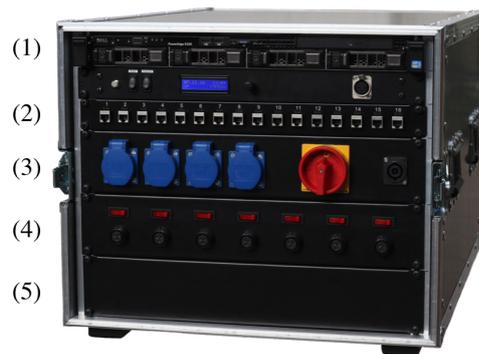
**Abb. 1.7.:** Frontansicht des RCS: (1) Datenserver, (2) 16-Port-Netzwerkswitch, (3) Steckdosen und Notaus-Schalter, (4) Anschlüsse für 7 APU-Kabel und (5) Blende mit Platz für weitere 7 APU-Kabel-Anschlüsse [65]
