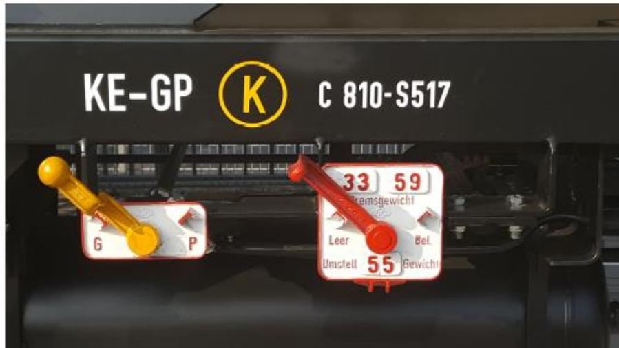
Abbildung 3: Handbediente Elemente an einem Güterwagen
