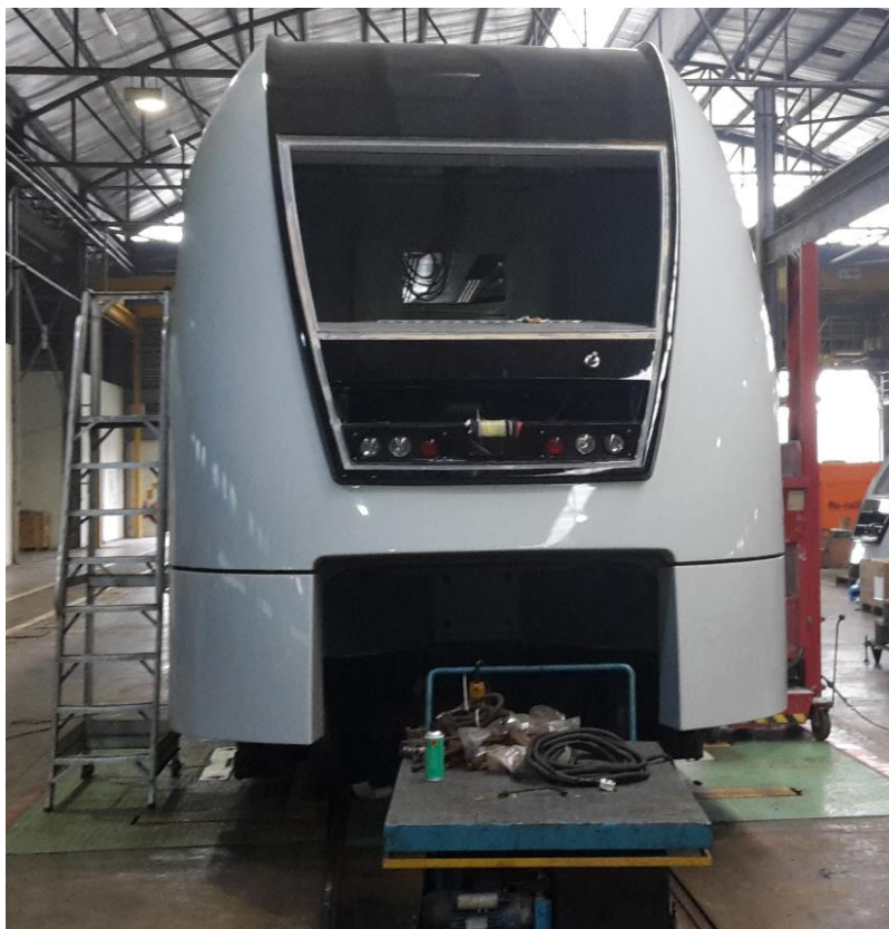
Abbildung 13: Die aufgesetzte Frontmaske auf den reparierten Wagenkasten, Bildrechte: DB Systemtechnik, M. Bretschneider
