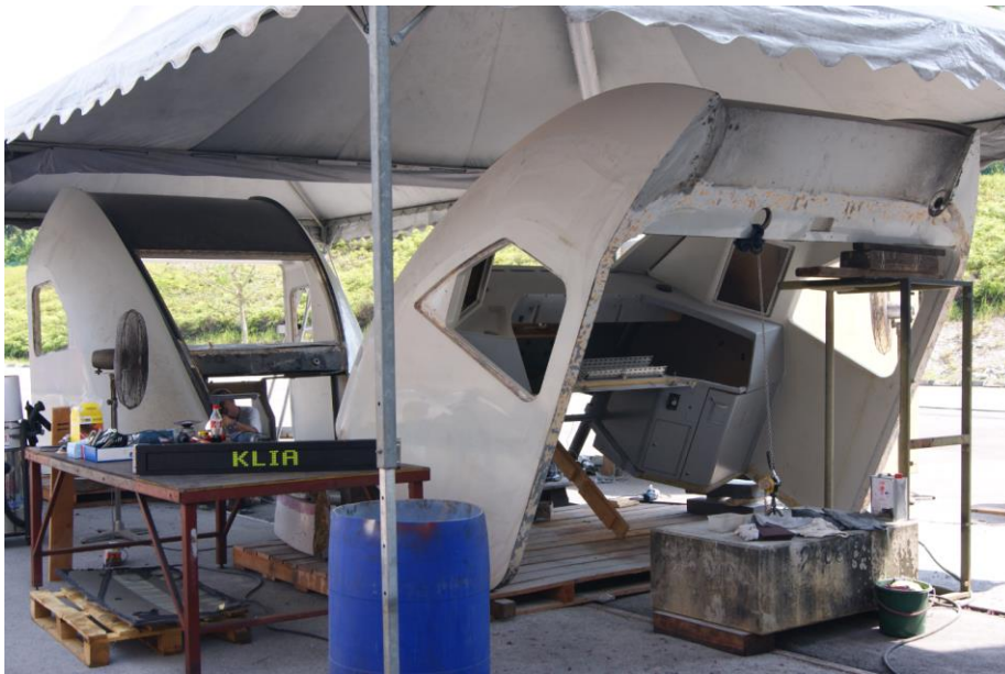
Abbildung 12: Eindrücke von der Reparatur/Fertigung der GFK-Frontmasken, Bildrechte: DB Systemtechnik, M. Bretschneider
