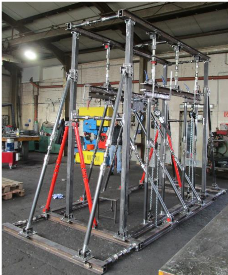
Abbildung 7: Probeaufbau der Abspannvorrichtung in Krefeld, Bildrechte: DB Systemtechnik, M. Bretschneider
