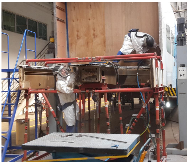
Abbildung 9: Durchführung von Schleif- u. Trennarbeiten, Bildrechte: DB Systemtechnik, M. Bretschneider
