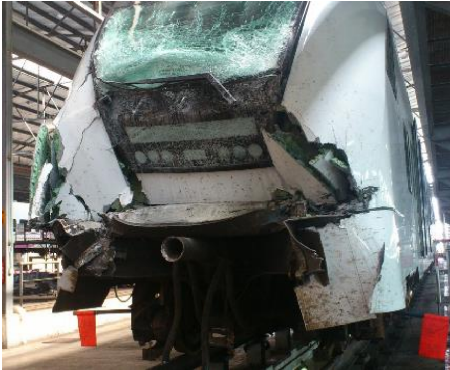
Abbildung 5: beschädigter Frontwagen nach dem Unfall 2014, Bildrechte: E-MAS, T. Baake
