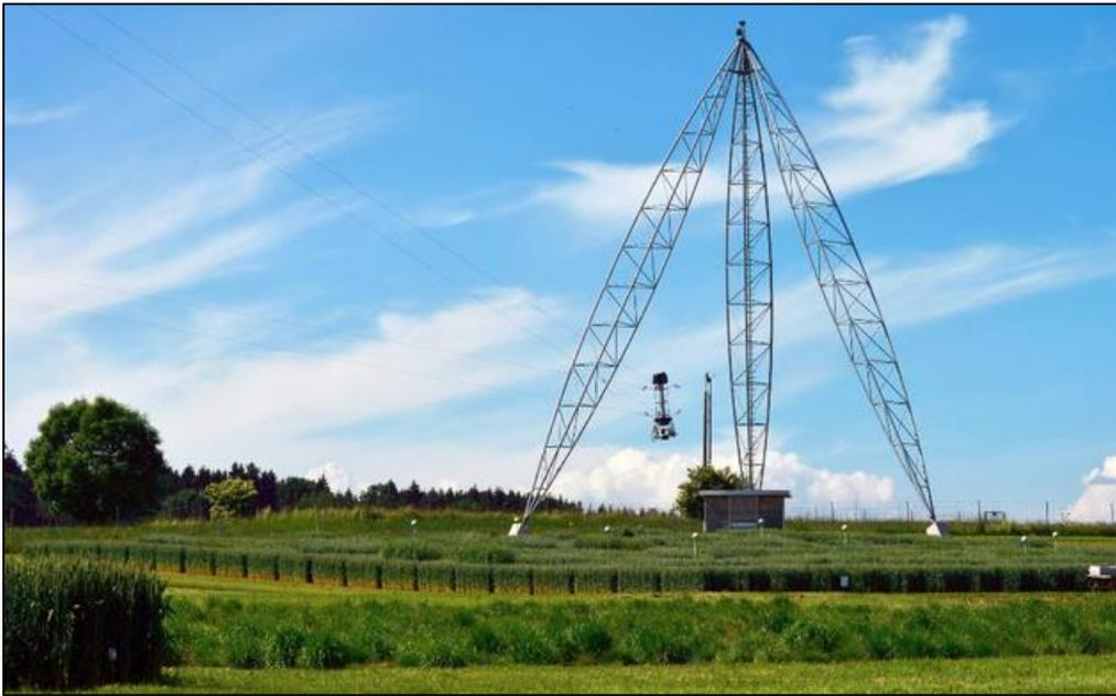
*Abbildung 5: Überwachung einer Feldlandschaft mit einer schwebenden Infrarotkamera [19]*
