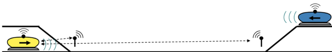
Abbildung 4: Eingleisige Strecke mit Fahrzeugen im autonomen Betrieb
