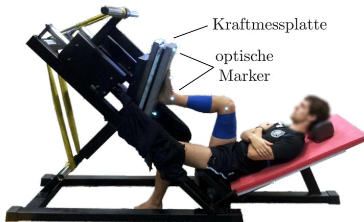
**Abb. 3.20:** Versuchsaufbau an einer diagonalen Beinpresse mit einer Kraftmessplatte auf der Trittplatte sowie optischen Markern zur Bewegungserfassung.
