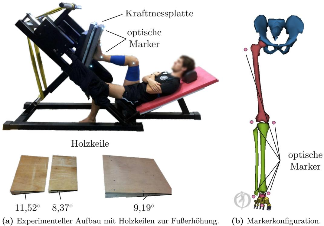
**Abb. 5.14:** Die beiden kleinen Holzkeile dienen einer medialen und lateralen Fußerhöhung, der große Holzkeil der Fersen- oder Zehenerhöhung. Abbildung 5.14b zeigt die verwendete Konfiguration aus sechs Markern zur Bewegungserfassung.
