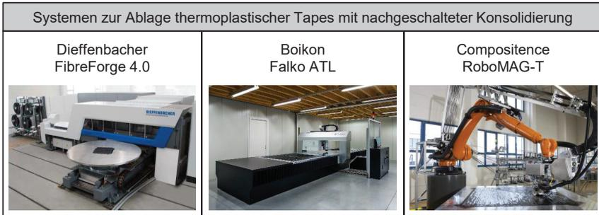
**Bild 2.10:** Systeme zum Ablegen partiell fixierter Tape Stapel [DIEF17; BOIK17; LEIC15]
