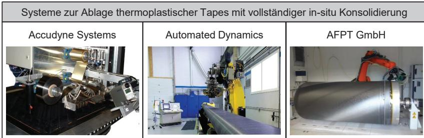
**Bild 2.11:** Systeme zum Thermoplast-Tapelegen mit in-situ Konsolidierung [ACCU17; AUTO17; HENN14]
