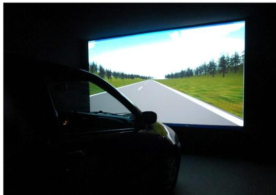
Abbildung 28. Simulationsumgebung des statischen Fahrsimulators am ISAC (Bildquelle: ISAC)
