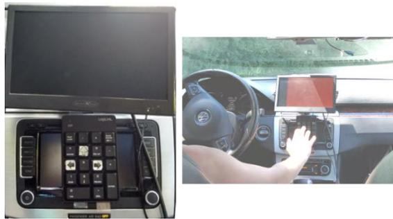
Abbildung 49. Aufbau der SuRT im Versuchsfahrzeug in der Realstudie (Studie 6)
