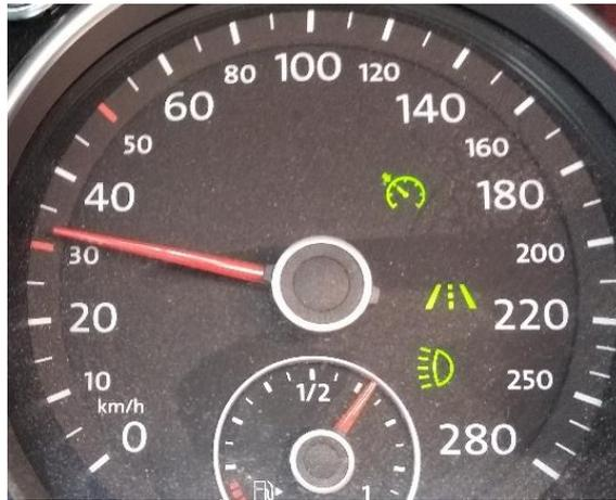
Abbildung 46. Symbole (Tempomat und Spurhaltung) im Instrumenten-Kombi bei aktiver automatisierter Fahrfunktion in der Realstudie (Studie 6)
