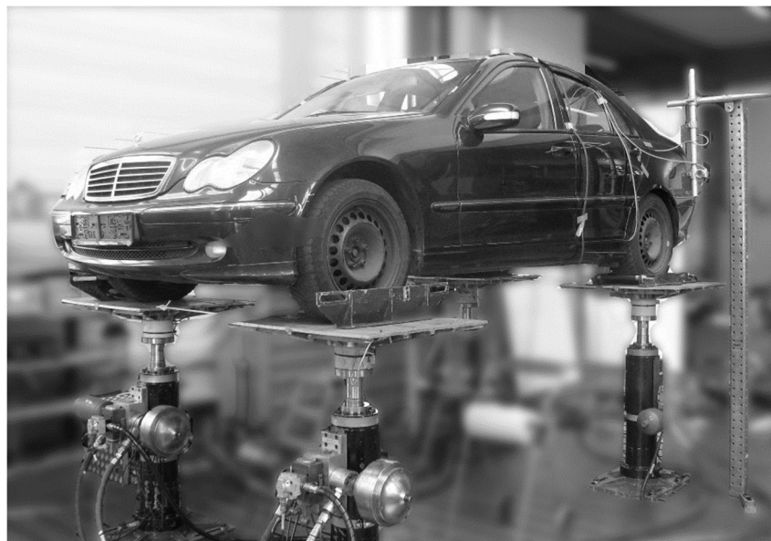
Abb. 6-1: Versuchsaufbau 4-Stempelanlage mit Versuchsfahrzeug
