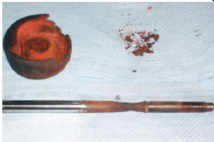
Korrosion durch Druckanschlag
