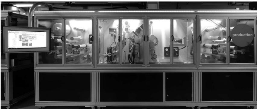
Bild 5.1: Modulare Rolle-zu-Rolle-Produktionsplattform in UV-Imprint-Konfiguration
