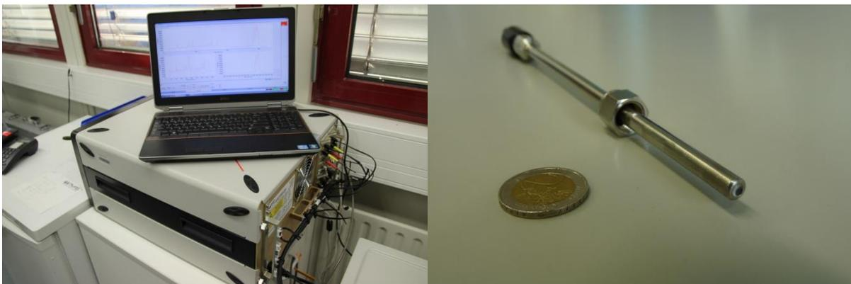
**Abbildung 9:** Das RXN2-Spektrometer (links) und die Raman-Tauchsonde mit Saphir-Linse (rechts). Spektrometer und Sonde werden über einen Glasfaser-Lichtleiter verbunden.
