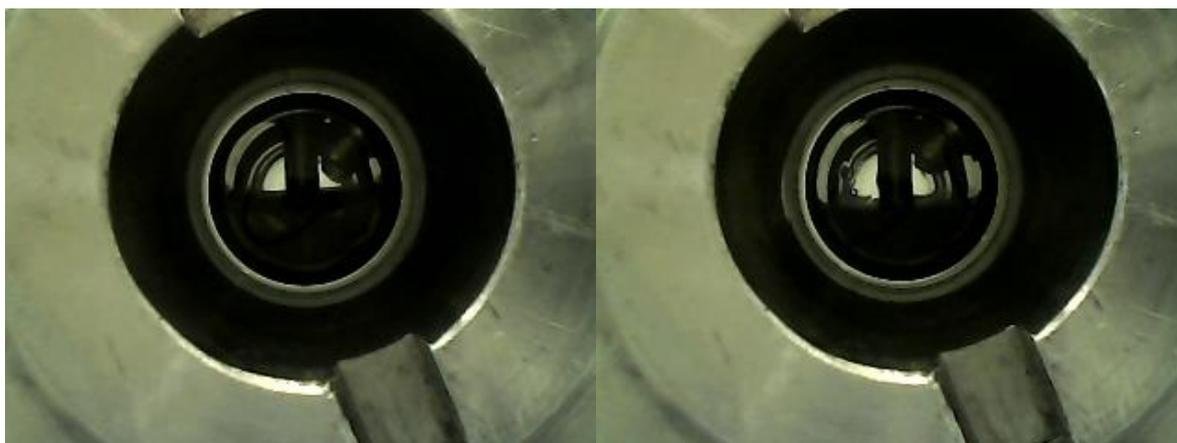
**Abbildung 13:** Bild durch das Autoklavenfenster zu Beginn der Reaktionszeit (links) und gegen Ende der Reaktionszeit (rechts) [51]. Der Füllstand sinkt mit der Zeit ab, da die Dichte des Produkts größer ist als die Dichte der Substrate.
