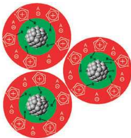
Abb. 8: Stabilisierung von Nanopartikeln durch eine Imidazolium-basierte IL und Hydride auf der Oberfläche (Abb. nach Campbell et al. [36] ).
