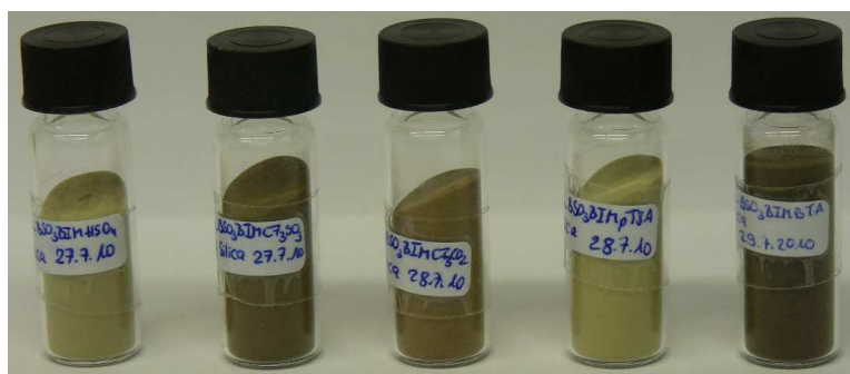
Abb. 24: Auf Silica 60 immobilisierte Ruthenium-Nanopartikel. Stabilisierende ILs von li. n. re.: [BSO 3 BIM][HSO 4 ] ( 8 ), [BSO 3 BIM][CF 3 SO 3 ] ( 5 ), [BSO 3 BIM][CF 3 CO 2 ] ( 6 ), [BSO 3 BIM][pTSA] ( 4 ), [BSO 3 BIM][Tf 2 N] ( 7 ).
