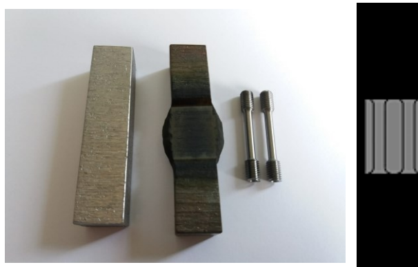
Abb. 6.7: Präparation der sekundären Proben aus dem umgeformten Bereich einer TTS-Probe.
