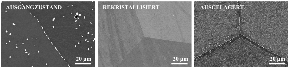
Abb. 7.27: Mikrostrukturentwicklung während des konventionellen thermischen Prozesses: REM-BSE-Aufnahme, poliert, 500-fache Vergrößerung.
