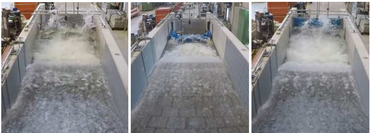
Abbildung 12: Testphase 4 – Wellenanprall auf HWS-mobil , Hydrobaffle und Aquawand .
