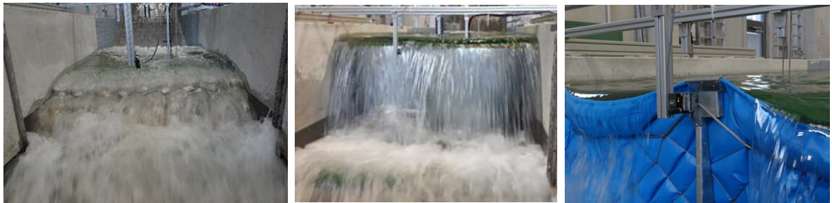
Abbildung 11: Testphase 3 – Überströmen von Sandsackdeich , HWS-mobil und Aquawand .
