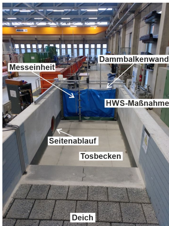
Abbildung 6: Versuchstand (links: Blickrichtung von Deichkrone, rechts: polderseitiger Blick).
