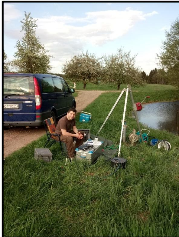
**Abb. 16: Probenahme an BV 214/86 mit Tauchpumpe, Durchflusszelle und WTW-Geräten zur VOP-Bestimmung; Probenahmekampagne 2018 (siehe Abb. 15).**
