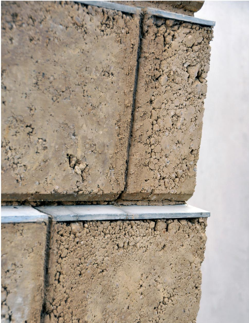
Abb. 4-27: Erosionsbremse - Testwand A1 (Detailaufnahme) Bearbeitung: Marc Donven, Laurent Neu
