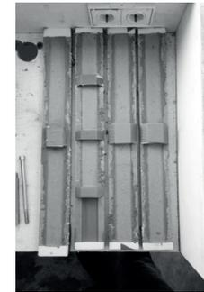
Abb. 4-21: Schalkörper für Erosionsbremsen
