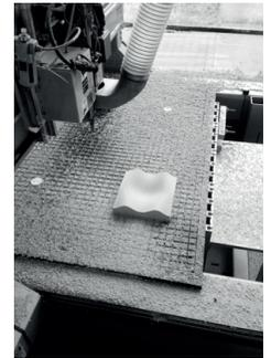
Abb. 4-23: Negativform zur Erstellung der Oberflächenwölbung
