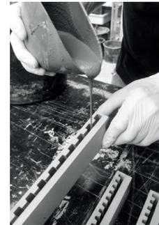
Abb. 4-40: Vorfertigung von Erosionsbremsen mittels starrer Kunststoffformen
