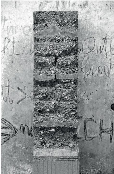
Abb. 4-51: Testwand mit Erosionsbremsen aus Kalkmörtel
