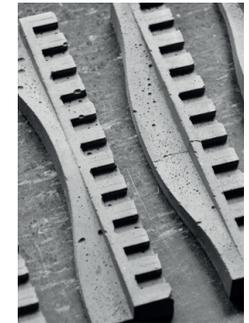
Abb. 4-42: fertige Erosionsbremsen
