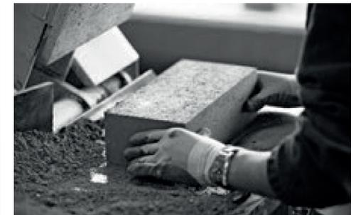
Abb. 2-3: Stabilisierter Lehmstein (Fa. Terrabloc)
