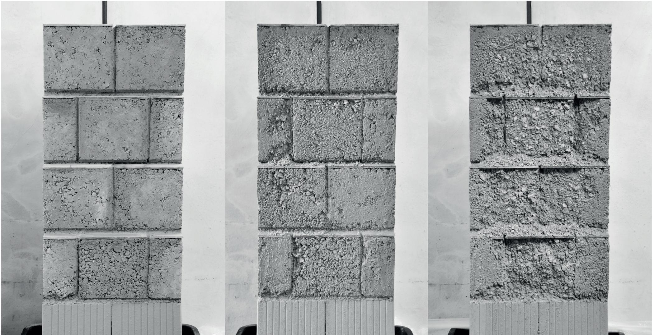
Abb. 4-28: Erosionsbremse - Testwand A1 (vor Beregnung / nach 5 min. Beregnungsdauer / nach 10 min. Beregnungsdauer)
