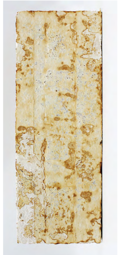
Bild 3 : Prototyp der Verbundwand. Das Pilzmyzel ermöglicht die Verbindung der einzelnen Elemente in einem zweistufigen Wachstumsprozess.
