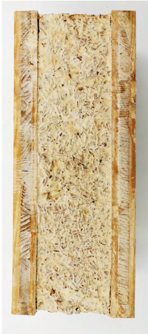
Bild 2 : Prototyp eines Sandwichpaneels mit einem Kern auf Myzelbasis in einem frühen Entwicklungsstadium.
