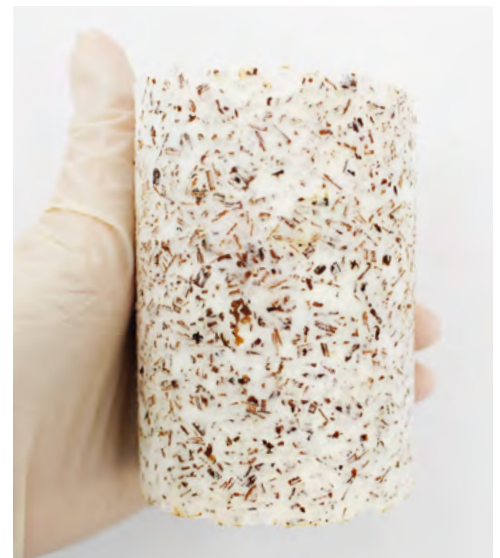
Bild 5 : Probekörper Z1 für Druckuntersuchung; Seitenansicht
