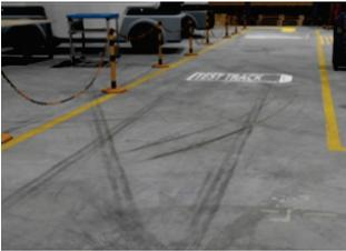
Testfall 7 zeigt einen durch Dreck, Reifenspuren und Bemalungen verunreinigten Hallenboden. Die in der Praxis mit der Zeit eintretenden Veränderungen weichen von dem ursprünglich trainierten Hallenboden ab. Die Robustheit der Algorithmen demgegenüber wird ohne Hindernisse erprobt.
