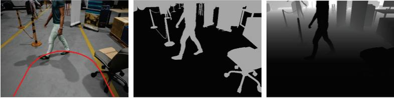
**Abbildung 5.2:** Grundwahrheitsdaten aus der Simulationsumgebung: Bild mit Sicherheitszone (links), Grundwahrheit für die Semantische Segmentierung (mitte), Grundwahrheit des Tiefenbilds (rechts).
