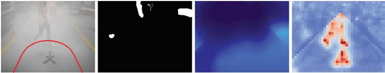
**Abbildung 7.10:** Beispieldetektionen bei Sichtstörungen durch Qualm: Keine rechtzeitige Detektion der Semantischen Segmentierung (Bild 2) und der Tiefenbildprädiktion (Bild 3). Robuste Detektion der Anomaliedetektion (Bild 4).
