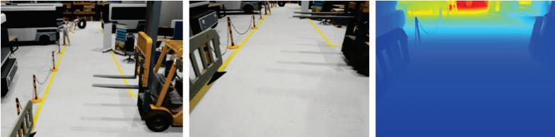
**Abbildung 2.6:** Hinderniserkennung mittels Tiefenbildschätzung; Methode nach ALHASHIM und WONKA<sup>53</sup>: Szenenüberblick (links), Kamerabild (mitte), Tiefenschätzung mit fehlerhafter Schätzung bei den Gabelstaplerzinken (rechts).
