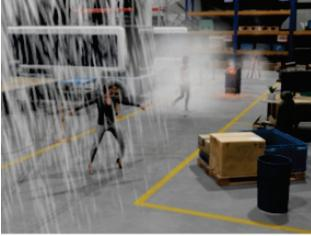
Testfall 5 dient der Validierung visueller Störungen. Hierbei wird die Reaktion auf Niederschlag, leichten bis hin zu starken Qualm und Funken getestet. Mit extremen Betriebsbedingungen ist insbesondere im Außenbereich zu rechnen.
