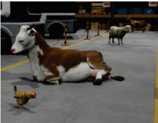
Testfall 2 adressiert neuartige Objekte. In Fabriken befinden sich oft Objekte, die kantig und aus Holz oder Metall gefertigt sind. Der Testfall hingegen konfrontiert die Algorithmen mit unüblichen Objekten wie Tieren, Pflanzen oder mythischen Kreaturen, die nicht Teil des Trainings sind.
