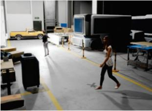
Testfall 6 analysiert den Einfluss von Beleuchtungswechseln. Dazu wird die Detektionsgüte der Objekte aus Testfall 1 mit erhöhter und reduzierter Helligkeit getestet. Zudem wird der Einfluss tiefstehender Lichtquellen mit starkem Schattenwurf erprobt.
