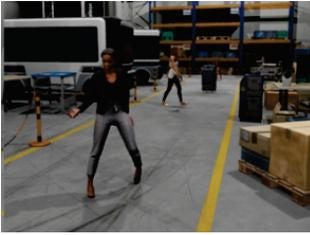
Testfall 1 zeigt den Hallenweg mit 15 produktionsüblichen Objekten auf der Fahrbahn. Darunter sind Stühle, Feuerlöscher, Absperrungen, Kisten und zwei Menschen. Der Datensatz dient zusätzlich als Referenz bei der Untersuchung des Einflusses der Beleuchtung.
