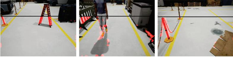
**Abbildung 2.4:** Hinderniserkennung mittels des Optischen Flusses; Methode nach MOLINEROS et al.<sup>36</sup>; Detektion aufgrund der perspektivischen Transformation nur unterhalb der Linie möglich. Gute Erkennung der Leiter (links), nicht fehlerfreie Erkennung des Menschen (mitte), Robustheit gegenüber flachen Objekten (rechts).
