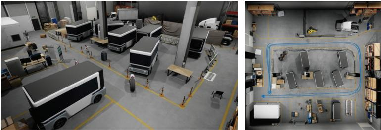
**Abbildung 5.1:** Virtuelle Nachbildung der Anlaufabrik der RWTH Aachen in Unreal Engine 4 (links), Draufsicht mit beispielhaft eingezeichneten Fahrzeugtrajektorien zur Generierung der Datensätze (rechts).
