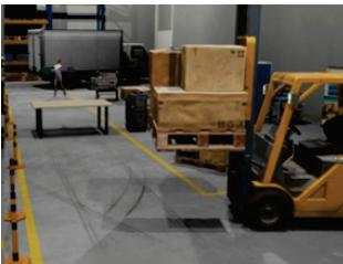
Testfall 4 zeigt Objekte, die über dem Boden zu schweben scheinen, wie eine von einem Gabelstapler transportierte Palette oder ein langes Fahrzeug mit Abstand zum Boden. Hieran soll untersucht werden, ob eine Tiefenbildprädiktion Vorteile gegenüber einer zweidimensionalen Anomaliedetektion hat.
