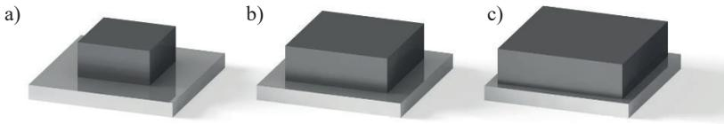
Abbildung 4.6 – Positionierung und Bauplattformbelegung innerhalb einer Messposition für die Quantifizierung von Diskontinuitäten für eine Plattformbelegung von a) 25 %, b) 50 % sowie c) 75 %
