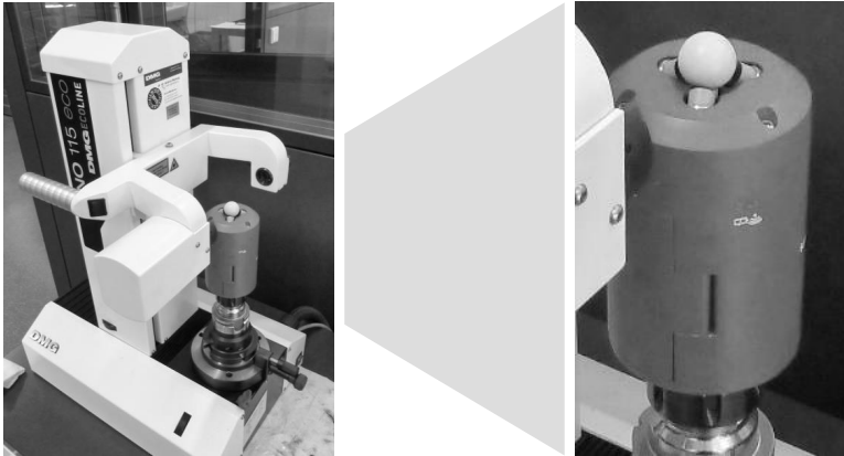
Bild 4.4: Sensorsystem auf Werkzeugeinstellgerät Sensor System on Tool Setting Device
