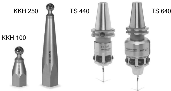
Bild 4.9: Messkugelhälter und Messtaster nach [HEID09]
