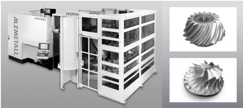
Bild 2.2: Automatisierungslösung für Serienproduktion nach [ALZM13] und [GFMS16] Automation Setup for High-Volume Production
