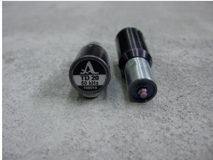
Abbildung 2.2: Punktkontaktprüfkopf der Firma ACSYS
