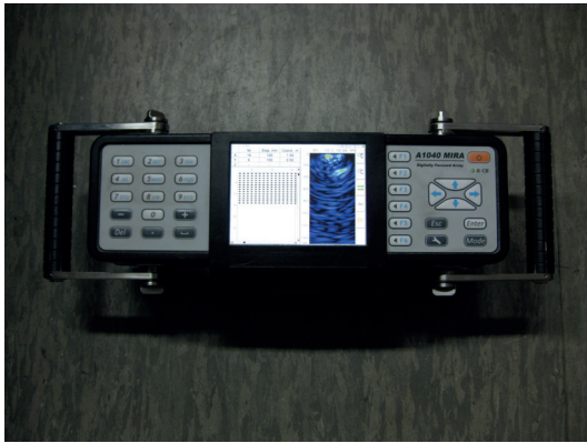
Abbildung 2.4: A1040 MIRA der Firma ACSYS in der Draufsicht mit im Display dargestelltem SAFT-Ergebnis
