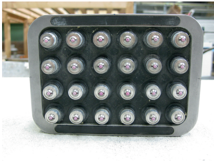
Abbildung 2.3: Arrayprüfkopf des kommerziell erhältlichen Gerätes A1220 der Firma ACSYS
